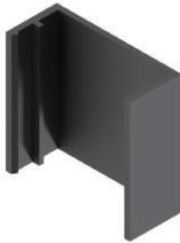
El perfil de aluminio base lateral, se fija a los laterales del Annapurna 80x80 mm, mediante el tornillo 7504B 4x40 mm. La separación entre los tornillos de fijación será como máximo de 400 mm. En la zona en la que se aloja el tornillo, se debe realizar un taladro previo con broca de 3,5 mm y 50 mm de largo aproximadamente. Este taladro atravesará el perfil de aluminio base lateral, en Annapurna 80x80mm y el poste.
