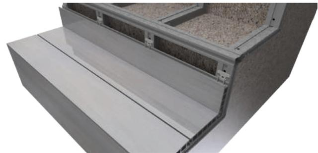
Del mismo modo que en el primer peldaño, colocaríamos el adhesivo MS en el rastrel del borde del peldaño, y colocaríamos el manperlán. Para la pieza de la contrahuella, en lugar del clip convencional, se podría emplear también clip de inicio como se aprecia en la siguiente imagen rodeado en rojo.
