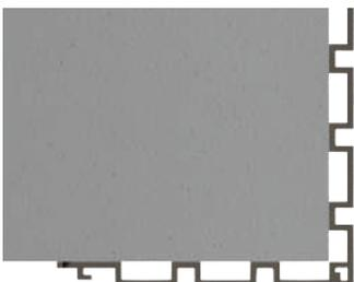
En el siguiente ejemplo, se recorta un panel, de manera que se maximiza el contacto entre ambos para realizar una fijación con adhesivo de PVC a lo largo del perfil.
