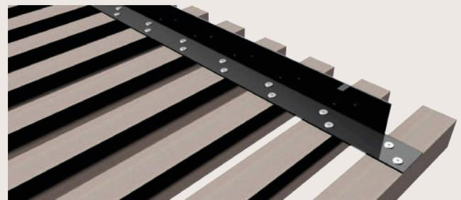
Colocado este último ángulo, ya tenemos la parrilla completa para colocar en el marco rectangular fijado sobre el marco y los perfiles horizontales fijados en la pared.
