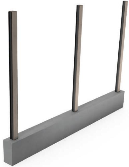
Fijados los perfiles de aluminio laterales, se cortan las tapas de aluminio a la longitud que se desea que estén separados entre sí los perfiles Annapurna de la valla.
