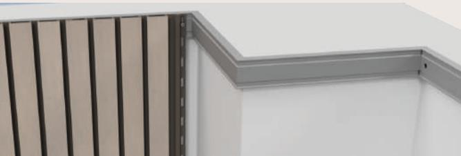
Como se aprecia en la imagen anterior, el último panel colocado, no llega a cubrir la totalidad de la pared, más aún, teniendo en cuenta que la parte del perfil de fijación, no debe quedar vista.
