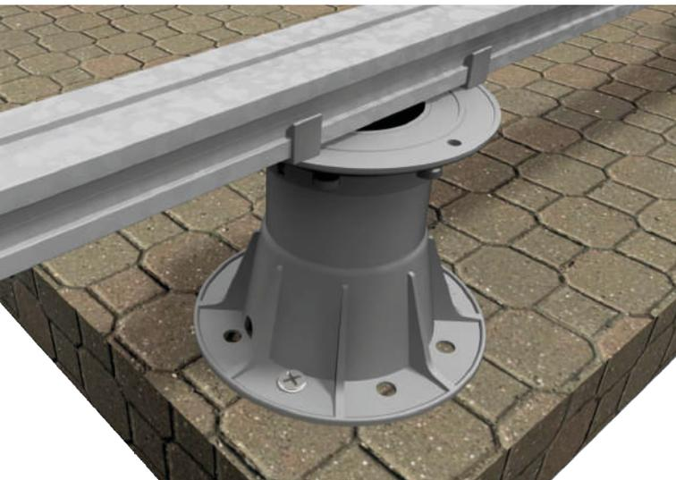
Los plots utilizados en la instalación, al igual que sucede con el rastrel cuando va sobre cuñas, **se deben fijar al suelo** utilizando tornillos de golpeo que penetren, al menos, **50 mm**. **Según la naturaleza del suelo, la Dirección Facultativa de la obra puede modificar el tipo de fijación para garantizar la estabilidad del rastrelado.**
