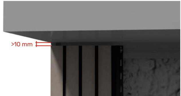
Como se muestra en las imágenes anteriores, la **junta de dilatación entre testas** de lama será de **6 mm**, para lamas de hasta 3 m de longitud. Las **juntas de dilatación perimetrales** (de testa a techo o de testa a suelo) serán de **10 mm**.
