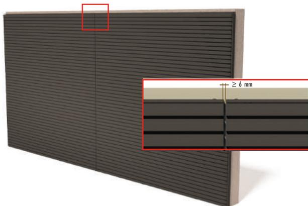
De igual modo que puede ocurrir en instalaciones de interior, la última lama no podrá colocarse en toda su anchura. La lama se cortará longitudinalmente a la anchura deseada. La separación mínima entre el extremo de la lama y el suelo será de, al menos, 10 mm. En cualquier caso, tanto en suelo, pared como en techo, la junta perimetral será igualmente de 10 mm.
