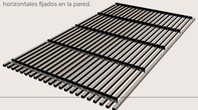
Levantamos el bloque de perfiles Annapurja fijados con los ángulos, y lo "colgamos" sobre el marco de perfiles de 40x40 mm fijado a la pared.
