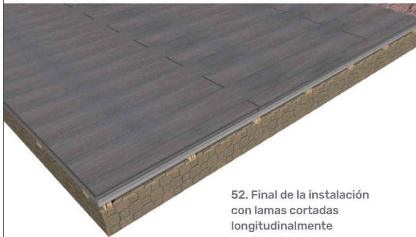
52. Final de la instalación con lamas cortadas longitudinalmente y colocadas.
