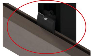
Continuamos colocando los perfiles Annapurna 50x30 mm siguiendo las indicaciones dadas, y llegados a la fila 10, colocamos un nivel para asegurar la horizontalidad o verticalidad de la instalación (según se instale el perfil Annapurna en horizontal o en vertical), y una vez el perfil nivelado, atornillamos el clip al rastrel, del mismo modo que hemos indicado con anterioridad.
