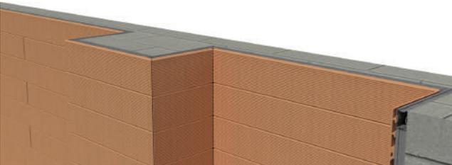
En el ejemplo mostrado en la fotografía anterior, se realiza una fijación mecánica en la lama superior. Como en este ejemplo, se utilizará como remate superior cantonera de 32x32 mm.
