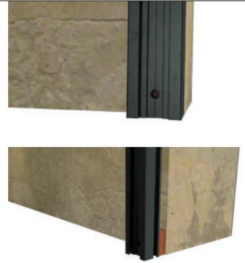
Los rastreles de la instalación, se fijan al sustrato mediante tornillo-taco de golpeo de al menos 6 mm. Estos tornillos deben ser de acero inoxidable AISI 304, y AISI 316 si se la instalación se realizara en ambientes marinos.
