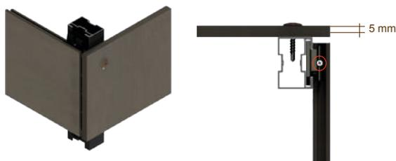
También es posible realizar la junta a inglete teniendo a ambos lados perfil Mont Blanc. Del mismo modo, la fijación de los perfiles perimetrales con el tornillo 7505A, se hará en el clip más externo. La junta de dilatación entre del inglete será de igual modo de al menos 5 mm.
