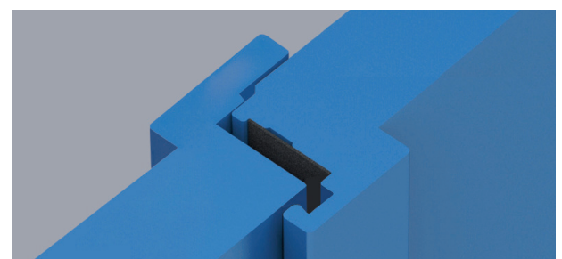
Coupe horizontale de la jonction des vantaux
