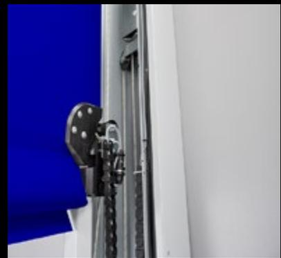
Bei einer Kollision kann sich die Schließkante in alle Richtungen verformen. Vorgespannte Seile gewährleisten eine kontrollierte Auslenkung, bis sich auch die Rastverbindungen zwischen Torblattabschluss und Führungsstücken lösen. Richtungsunabhängig gleitet anschließend der Torbehang aus den Zargenführungen.
