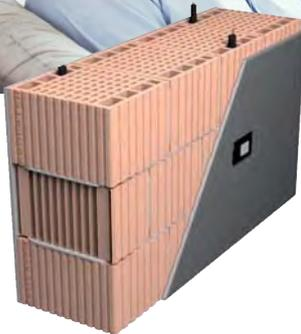
Il nuovo blocco acustico Evolater è stato concepito per offrire una soluzione efficace, duratura ed ecologica per garantire un elevato isolamento acustico tra unità abitative pari a **57db** in soli 25 cm di spessore. Inoltre, il blocco, in categoria I, possiede le caratteristiche per l'impiego negli edifici a muratura portante in zona sismica.
