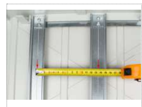
135mm between DIN rail 135mm entre rail DIN
