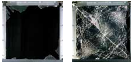
ガラスのみ (ガラス片が飛散)
