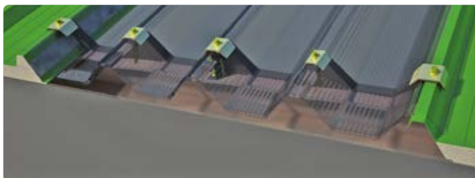
PIEDE DI COPERTURA Particolare sovrapposizione laterale con pannelli metallici coibentati. Fissaggio piede di copertura
