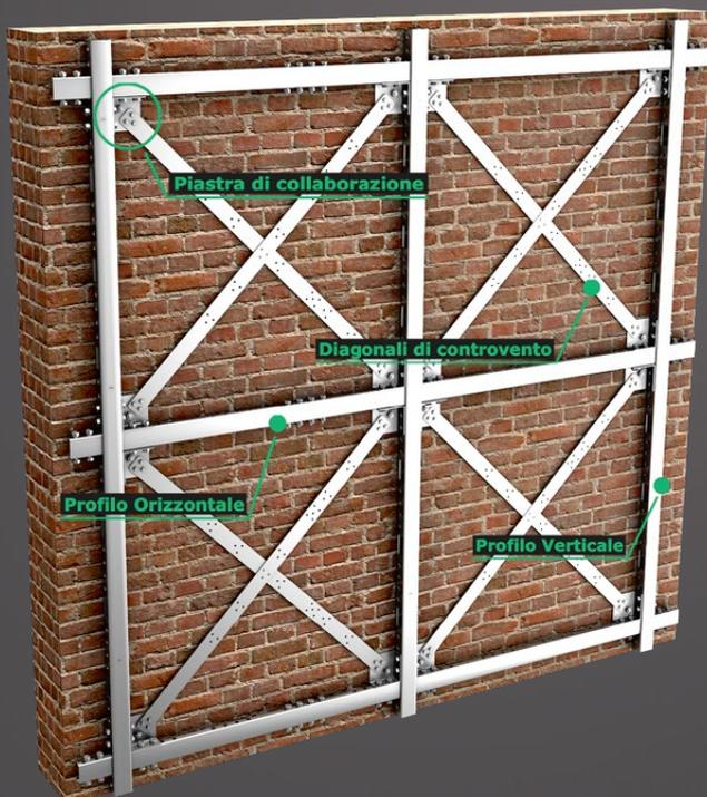
Il rinforzo degli elementi murari viene eseguito mediante elementi strutturali integrativi in acciaio collaboranti sulla superficie. Il sistema è composto da **elementi in acciaio opportunamente collegati fra loro** e connessi alla muratura.
