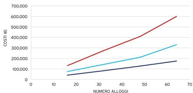
— VMC Helty FlowCOMPACT — VMC autonoma — VMC centralizzata
