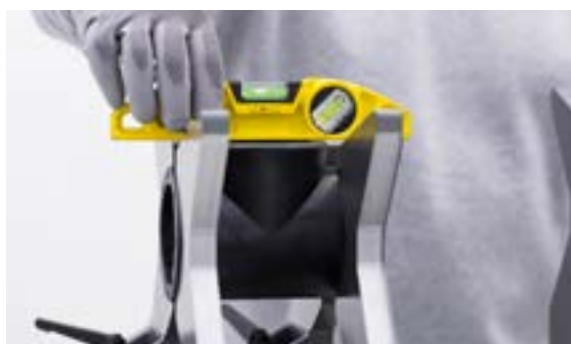
Nivelar el accesorio en la máquina
