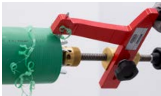
Raspar la superficie a soldar (mejor con raspador automático)
