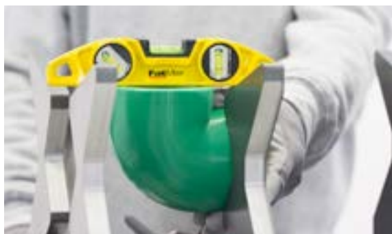
Nivelar el accesorio en la máquina
