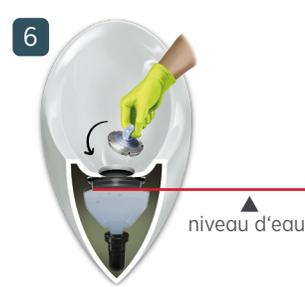
Remplissez l'eau jusqu'au point de débordement et mettez le couvercle en place.
