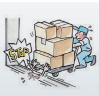
エキスパンション・ジョイント・カバーの上を、重量物運搬車やフォークリフトなどが通過する際に、その重量に耐えられる鉄板など(厚さ 6 mm 程度)を渡してください。
