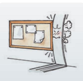
エキスパンション・ジョイント・カバーは動くのが正常な状態です。動かないように、他の材料で固定したりすることは、絶対にしないでください。脱落したり変形する恐れがあります。
