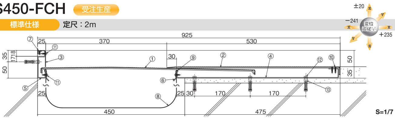
①センターブレート(t=1.5+3.0) ②フレームカバー(t=1.5+3.0) ③コーナーフレームカバー ④フレーム ⑤コーナーフレーム
