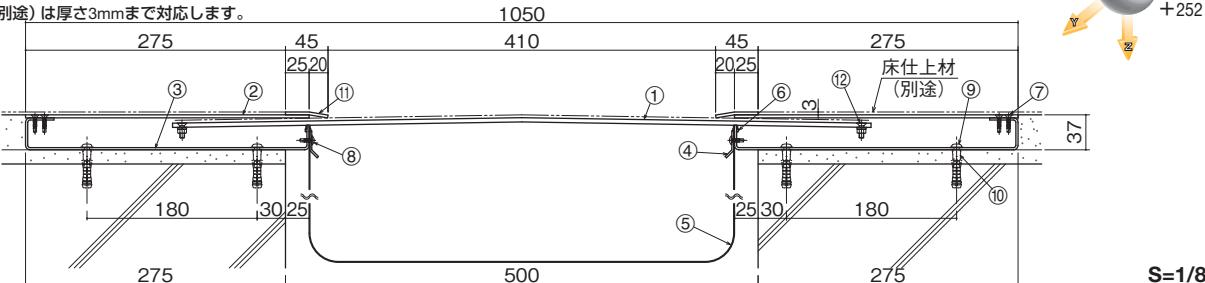
①センタープレート ( $t=4.5$ ) ②フレームカバー ( $t=3.2$ ) ③フレーム ④止水補助シート押え ⑤止水補助シート (別発注) ⑥FWパッキン ⑦ドリルねじ (皿頭4×19)
