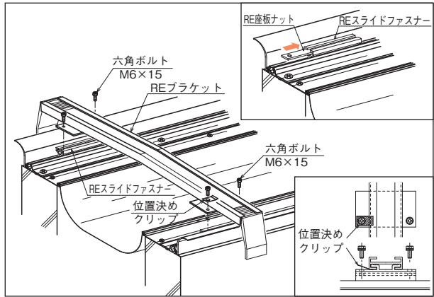
**4** REスライドファスナーにRE座板ナットを差し込み、REブラケットをRE座板ナットのねじ穴に合わせ六角ボルト(M6×15)で4箇所締め付け固定します。その内1箇所に「位置決めクリップ」を入れてREブラケットを固定してください。
