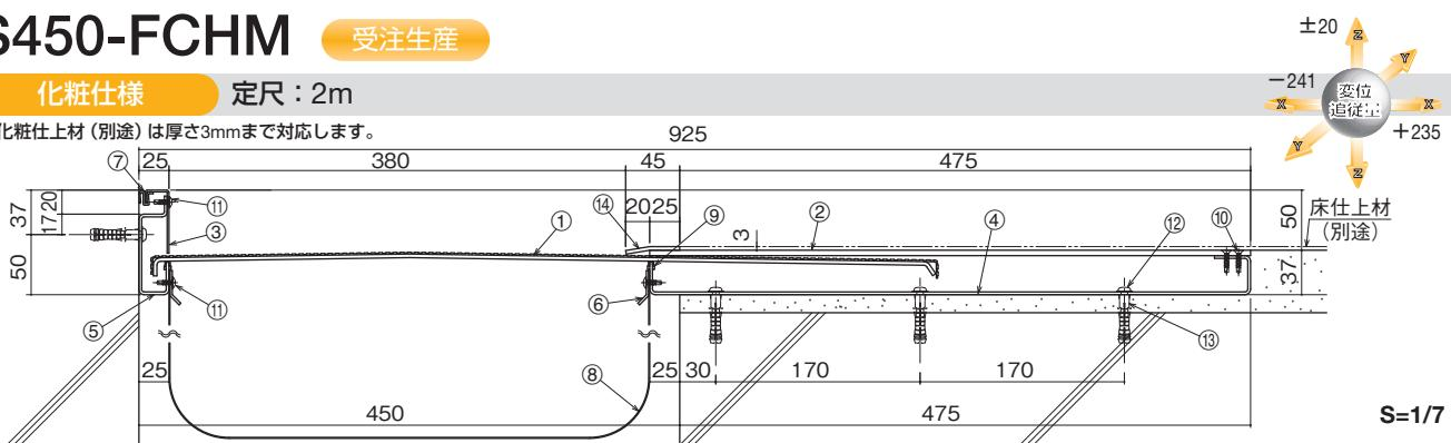
①センターープレート(t=1.5+3.0) ②フレームカバー(t=4.5) ③コーナーフレームカバー ④フレーム ⑤コーナーフレーム
