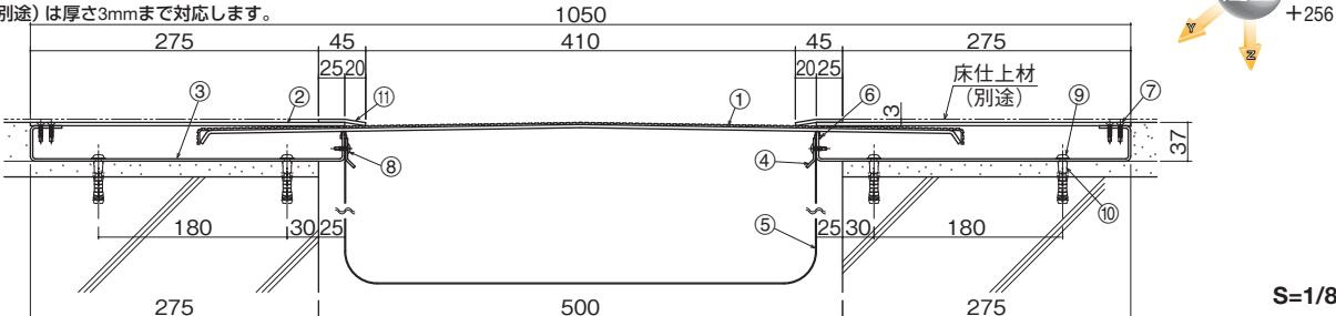
①センタープレート ( $t=2.0+3.0$ ) ②フレームカバー ( $t=3.2$ ) ③フレーム ④止水補助シート押え ⑤止水補助シート (別発注) ⑥FWパッキン
