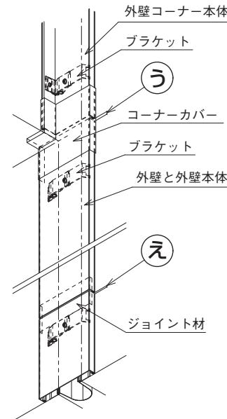
③部：本体と本体の隙間を10mm程度空け、上からコーナーカバーをかぶせて納めます。
