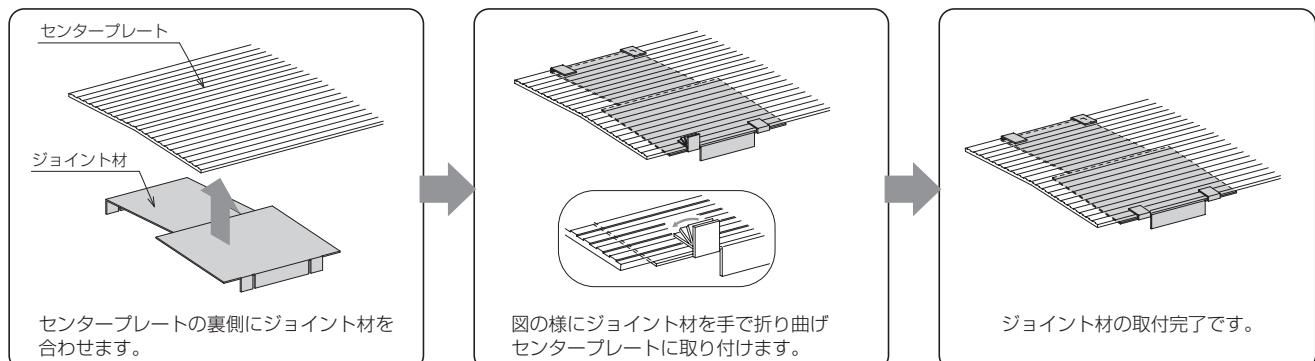
※センターブレードの断面形状で両端に返し(折り曲げ)がある製品については、上図の様にジョイント材を折り曲げて取り付ける形状ではありませんので、先にジョイント材の必要位置にジョイント材をフレームの上に配置し、その後、センターブレードを被せてください。
