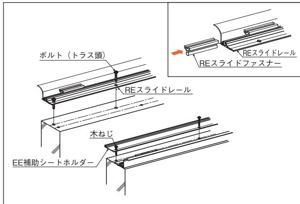
**2** REスライドレールにREスライドファスナーを使用するブラケットの数量分差し込んだ後、REスライドレールをボルト(トラス頭)で軸体に固定します。
