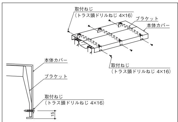
**6** 付属の取付ねじ(トラス頭ドリルねじ 4×16)で、本体カバーをブラケットに固定して取付完了です。
