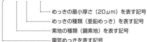
例2. 鋼素地上、電気亜鉛めっき3級
