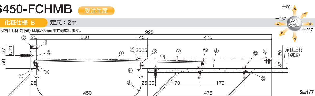
①センターブレート(t=4.5) ②フレームカバー(t=4.5) ③コーナーフレームカバー ④フレーム ⑤コーナーフレーム ⑥止水補助シート押え
