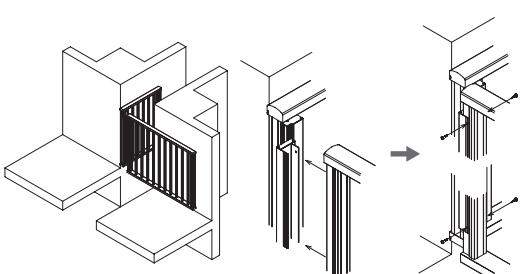
**4** 手摺りユニットをスライドさせ手摺りユニットAを手摺りユニットBの軸材に挿入し4か所ねじで固定します。手摺りユニットが水平になるように取り付けてください。
