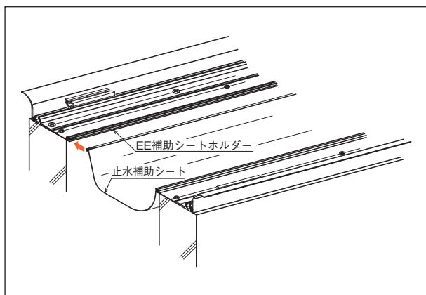
**3** 止水補助シートをEE補助シートホルダーに差し込みます。
