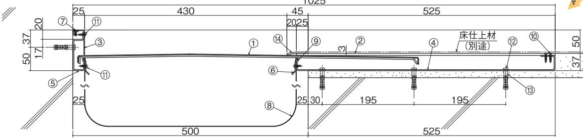
①センターブレート (t=2.0+3.0) ②フレームカバー (t=4.5) ③コーナーフレームカバー ④フレーム ⑤コーナーフレーム
