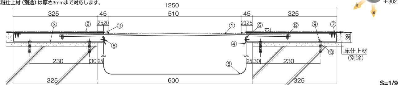
①センタープレート (t=6.0) ②フレームカバー (t=4.5) ③フレーム ④止水補助シート押え ⑤止水補助シート (別発注) ⑥FWパッキン ⑦ドリルねじ (皿頭4×19)
