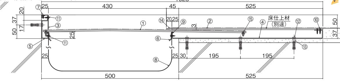
①センターブレート (t=4.5) ②フレームカバー (t=4.5) ③コーナーフレームカバー ④フレーム ⑤コーナーフレーム ⑥止水補助シート押え
