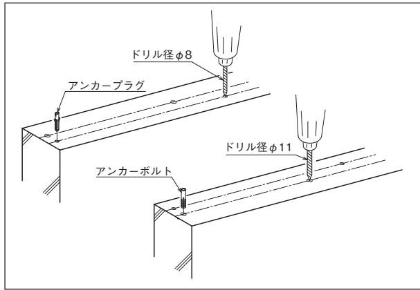
**1** 墨出しに基づき、REスライドレールの取付位置に $\phi 10.5$ の穴(400[450]mmピッチ)を開け、アンカーボルト(青黒色)を差し込みます。EE補助シートホルダーの取付位置には $\phi 8$ mmの穴(560[600]mmピッチ)を開け、アンカーブラグ(グレー色)を差し込みます。
