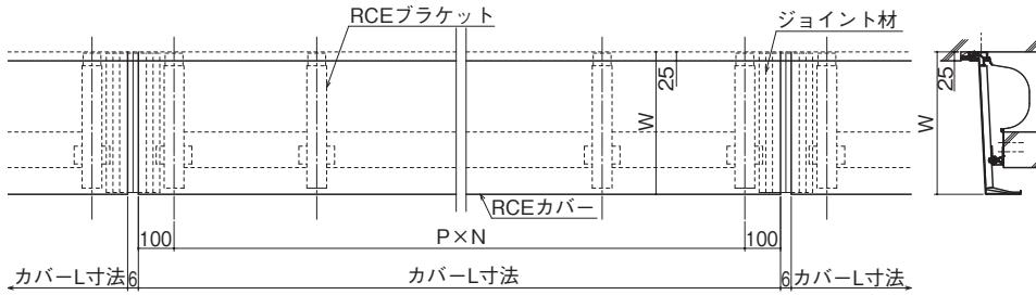
⚠ 熱膨張によりカバーの伸びが発生する事がありますので、ジョイント部分は6mm程度の目地をとってください。
