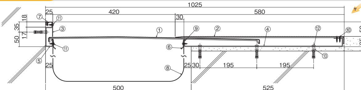
①センターブレート (t=2.0+3.0) ②フレームカバー (t=1.5+3.0) ③コーナーフレームカバー ④フレーム ⑤コーナーフレーム
