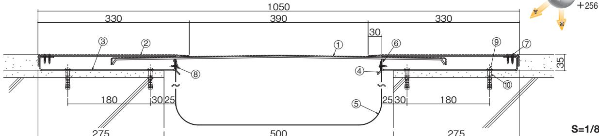
①センタープレート ( $t=2.0+3.0$ ) ②フレームカバー ( $t=2.0+2.0$ ) ③フレーム ④止水補助シート押え ⑤止水補助シート (別発注) ⑥FWパッキン
