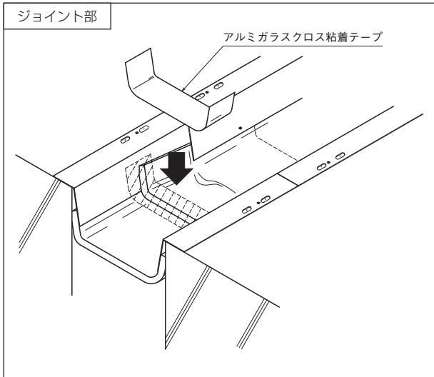
\*耐火帯のジョイント部を、付属のアルミガラスクロス粘着テープで、耐火帯の口が開かないように貼り付けます。
