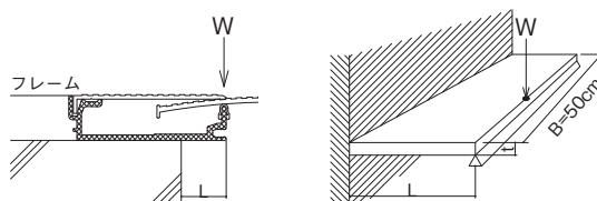
$\sigma b$ : 曲げ応力度 (N/cm<sup>2</sup>) M: 曲げモーメント (N·cm) Z: 断面係数 (cm<sup>3</sup>) L: 支持スパン (cm) t: 板厚 (cm)
