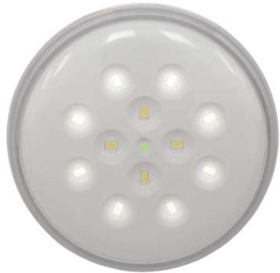
En emergencia, los 4 ledes centrales lucen, siempre en 5.700 K. Si el Orión estaba en modo permanente antes de entrar en emergencia, la corona de ledes se apaga.
