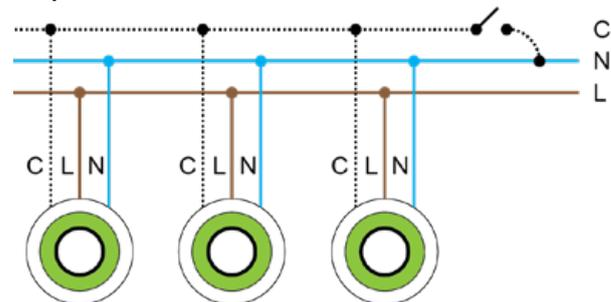
La línea de control C permite gobernar el encendido y apagado del led central en presencia de red (modo permanente o no permanente).
