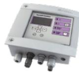
Überprüft monatlich automatisch die Funktion von Pumpe und Sonde. Bei Betriebsstörung oder unsachgemäßer Installation gibt das Gerät eine Warnmeldung. Mit Display, integriertem Selbstdiagnosesystem (SDS) und Batteriepufferung. Geeignet für Drucksteuerung, Leitwertsonden und Schwimmerschalter. Sofort anschlussfertig durch codierte Stecker.
