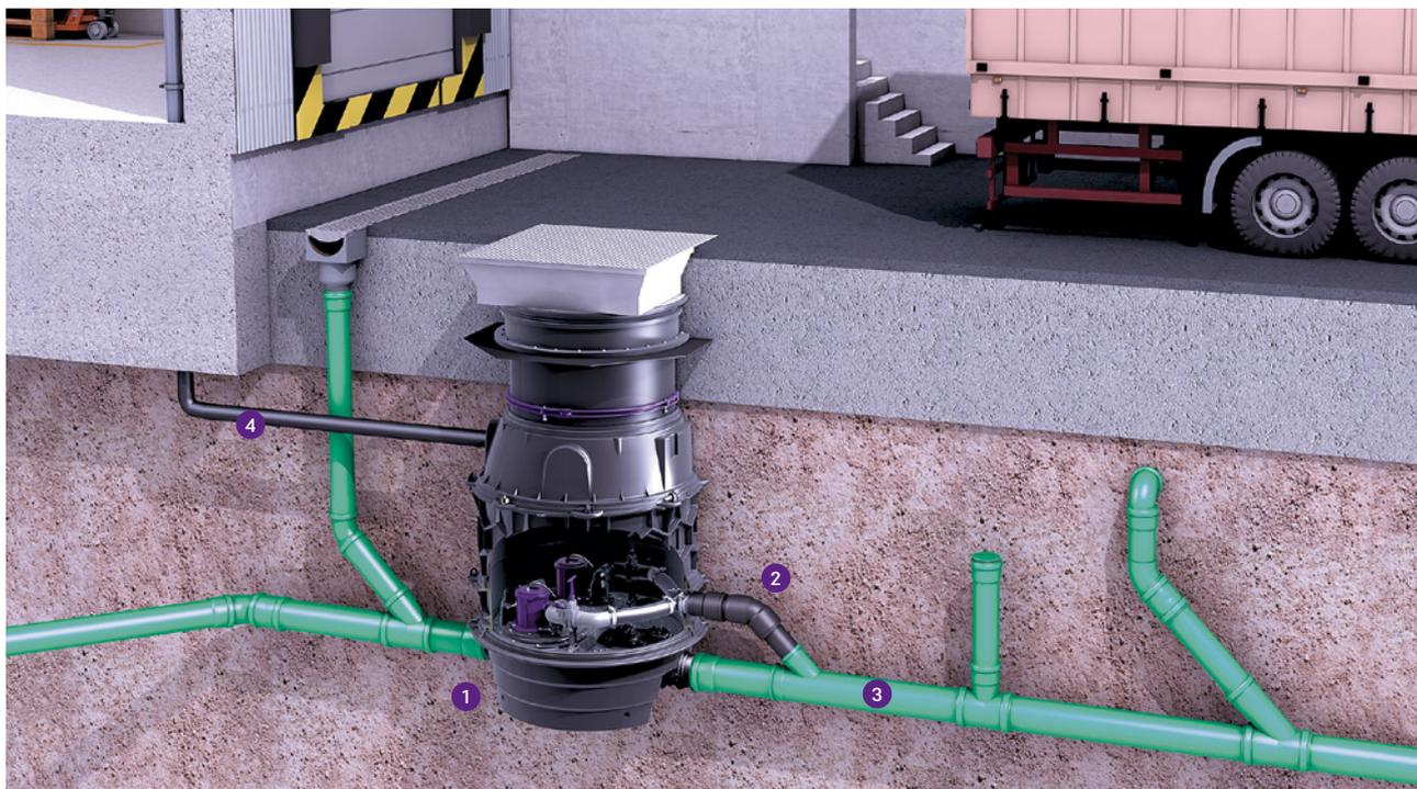
Ecolift kann in Österreich (gem. Ö-Norm B 2502) mit und ohne Druckschleife verbaut werden. Die Förderung des Abwassers mit einer Druckleitung über eine Rückstauschleife bietet eine höhere Sicherheit gegen Rückstau aus dem öffentlichen Kanal als eine Druckleitung unterhalb der Rückstauenebene.
