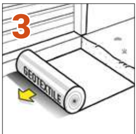
Mise en place du géotextile.
