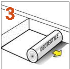
Mise en place du géotextile.
