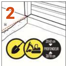
Préparation du fond de forme (voir nos conseils de pose en fonction des zones concernées).
