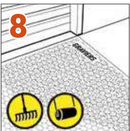
Remplissage et finition. Gravier concassé type 5/15 ou 8/16.
