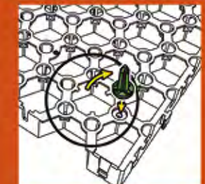
Die Verankerungstifte auf der Rückseite der Platte einsetzen
