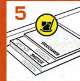
Deckschicht (Feinsand + Substrat) verlegen
