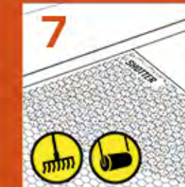
Auffüllen und fertigstellen
