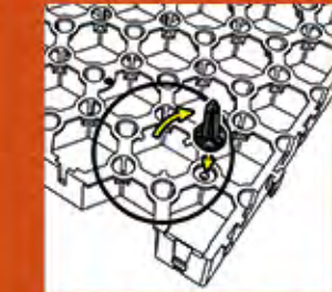
Bei Verlegung in Hanglage: Verankerungsstifte abschneiden und auf der Rückseite der Platte einsetzen.
