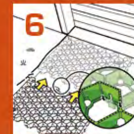
Greenplac® Unterlegplatten verlegen
