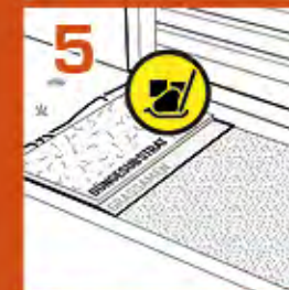
Deckschicht (Feinsand + Substrat) verlegen
