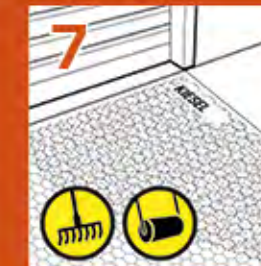
Auffüllen und fertigstellen
