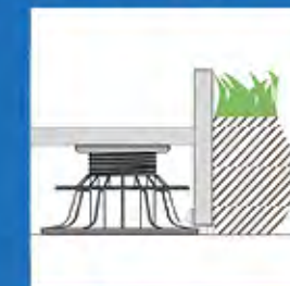
Ausführung mit Anschlag.
