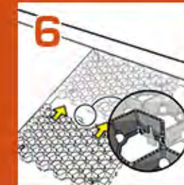
URBANGRAVEL® Unterlegplatten verlegen
