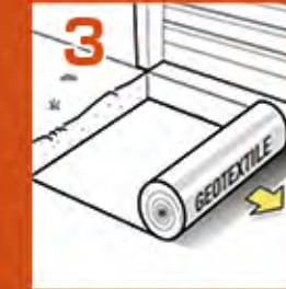
3 Lay the geotextile membrane.
