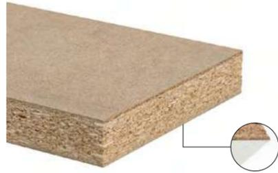
Holzspanplatte Typ P6 gemäß DIN EN 312, hoch belastbar, für tragende Zwecke zur Verwendung im Trockenbereich, einseitig melaminbeschichtet.
