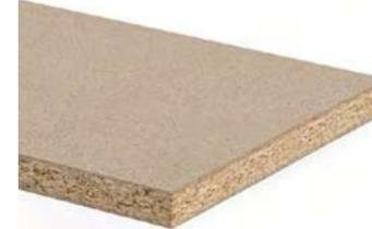
Harnstoffharzgebundene Holzspanplatte Typ P2 gemäß EN 312, geeignet für nicht tragende Zwecke im Trockenbereich.
