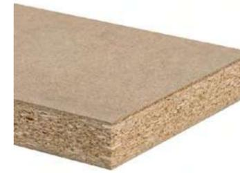
Holzspanplatte Typ P7 gemäß DIN EN 312, hoch belastbar für tragende Zwecke zur Verwendung im Feuchtbereich.
