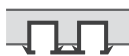
Double running track for press fitting รางเลื่อนบนคู่ สำหรับติดตั้งแบบฝัง
