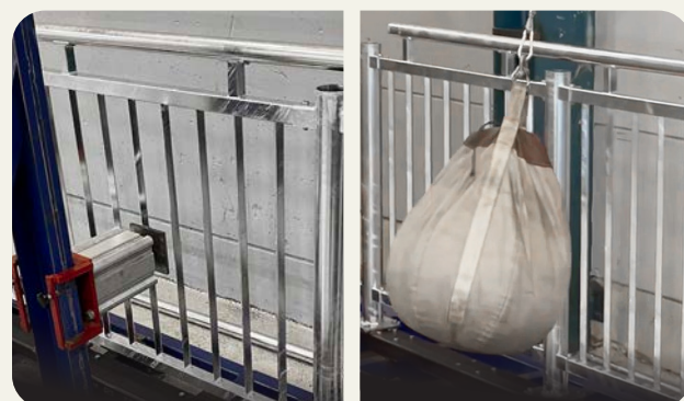
Testning av räcke vid dimensionering enligt TRVINFRA-00338.
