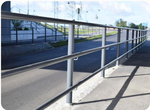
Ett GC-räcke skyddar mot avåkning vid höjdskillnader > 0,2 m längs cykelbanans kant. (Bild: FLEXI GC)
