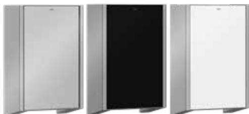
Händetrockner für Aufputzmontage, aus Chromnickelstahl, Oberfläche seidenmatt mit InoxPlus Oberflächenveredelung zur Reduzierung von Fingerabdrücken und besseren Reinigungseigenschaft (easy to clean), Materialstärke 1,2 mm, mit berührungsloser opto-elektronisch gesteuerter Annäherungssensorik, verstellbare Warmluft-Temperatur, Sensorreichweite einstellbar von 10 - 25 cm, Dauerlaufschutz mit Selbstabschaltung nach 60 Sekunden, Luftgeschwindigkeit einstellbar, Kabel und Stecker bauseits.
