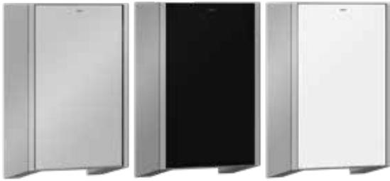
Händetrockner für Aufputzmontage, aus Chromnickelstahl, Oberfläche seidenmatt mit InoxPlus Oberflächenveredelung zur Reduzierung von Fingerabdrücken und besseren Reinigungseigenschaft (easy to clean), Materialstärke 1,2 mm, mit berührungsloser opto-elektronisch gesteuerter Annäherungssensorik, verstellbare Warmluft-Temperatur, Sensorreichweite einstellbar von 10 - 25 cm, Dauerlaufschutz mit Selbstabschaltung nach 60 Sekunden, Luftgeschwindigkeit einstellbar, Kabel und Stecker bauseits.
