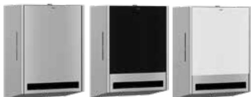
Manueller Papierhandtuchspender für Aufputzmontage, Chromnickelstahl, Oberfläche seidenmatt, Front und Gehäuse mit InoxPlus Oberflächenveredelung zur Reduzierung von Fingerabdrücken und besseren Reinigungseigenschaft (easy to clean), Materialstärke 1,2 mm, für Rollen mit maximaler Breite 205 mm und maximalen Durchmesser 200 mm, Papierabrissslänge 260 mm, verstellbare Papierrollenhalterung für optimierte Papierausgabe, inklusive Befestigungsmaterial.
