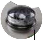
Nœud de **contrôle** placé dans le connecteur ZHAGA supérieur
