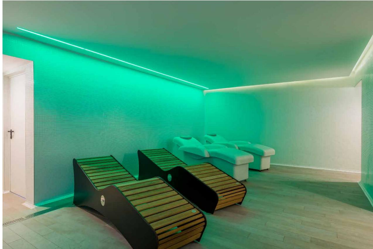
**ILUMINACIÓN LINEAL RGB** empotrada con difusor y de superficie en foseado. El sistema de control SCENA permite ajustar el color y la temperatura de los 2700K a los 6000K y adaptarla generando atmósferas de bienestar y descanso
