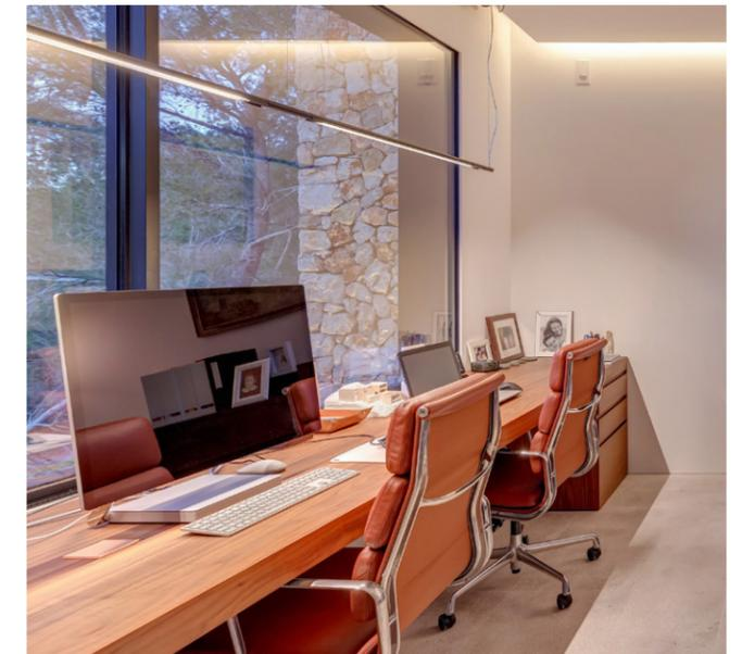
Combinación de tramos lumínicos de Slim System, que rotan 360° permiten extenderse proyectando un bañado de luz suave y uniforme sobre toda la superficie de trabajo, evitando deslumbramientos gracias al diseño de las aletas y su difusor.
