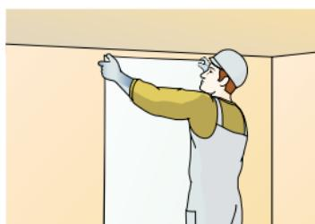
Se puede utilizar cualquier tipo de papel pintado sobre las placas de yeso. Emplear solo como adhesivos para el papel pintado, productos en base metil-celulosa o resinas sintéticas.
