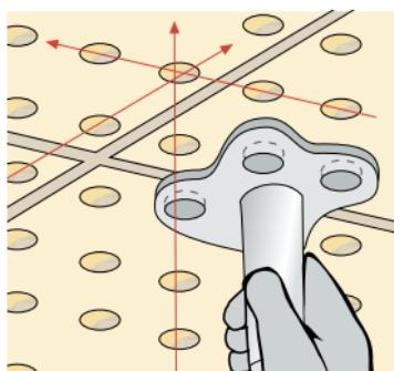
Para aplicar la pasta Placo® PR Multi se introduce la boquilla del cartucho en la junta. Es muy importante que la pasta llegue a la parte superior de la junta y la llene completamente dejando sobresalir por debajo un espesor de pasta de entre 5 y 8 mm.
