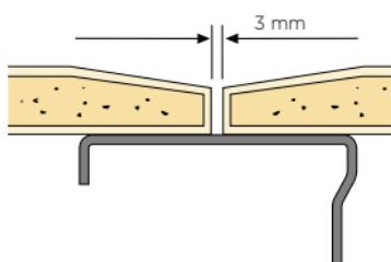
En el caso de estructura arriostrada en H, la junta entre las dos placas, deberá situarse sobre uno de los extremos, de manera que queden las placas atornilladas a un sólo montante.
