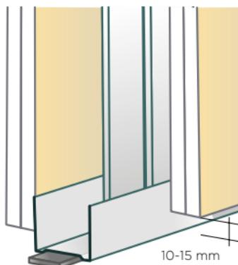
Si la solera se instala después del montaje del tabique, la parte inferior de éste deberá protegerse con un film de polietileno.
