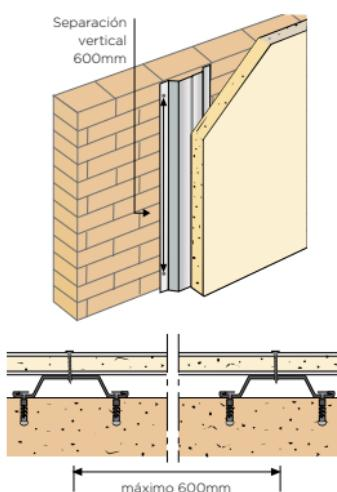
Las Omegas podrán fijarse verticalmente al muro cada 300, 400 ó 600 mm, según el espesor y número de placas a atornillar.
