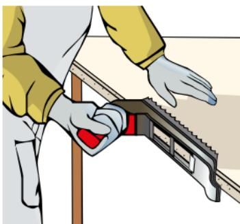
Para cortes complejos o especiales se utilizará la sierra de calar mecánica o manual.
