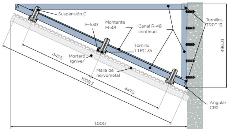
Formada por malla de Nervometal de 0,40 mm de espesor, mortero Igniver® de 32,8 mm de espesor, fijadas a las escuadras soporte de Placo®, confeccionadas con Railes de 48 mm, montantes de 48 mm, perfilería F-530 y tornillería.
