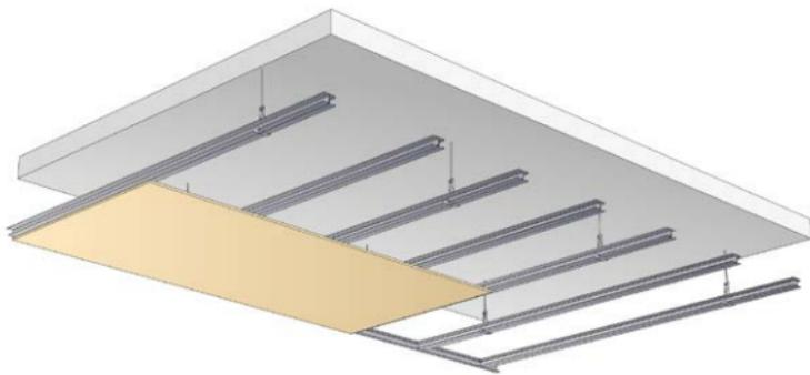
Los montantes se pueden instalar simples o dobles. En el caso de que se instalen montantes simples, la colocación en su parte superior de unas riostras hechas con raíles aporta mayor estabilidad y permite una mejor puesta de las placas de yeso, así como un reparto homogéneo de las cargas sobre los montantes.
