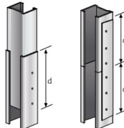
En trasdosados con estructura sencilla o doble arriostrada, no hay limitación de altura. Recomendamos el primer arriostramiento a 1,50 m del suelo.
