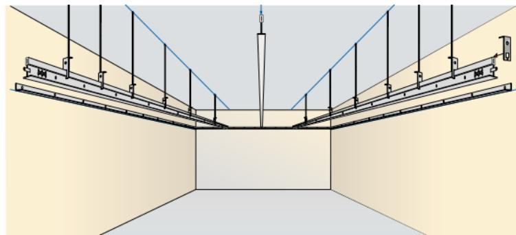
Para progresar en la longitud total del local, los perfiles primarios se irán conectando a testa.
