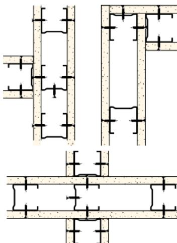
Para reforzar los montantes se colocarán en "H" tal y como se indica en la figura. La unión mecánica entre ellos se realizará por medio de tornillos TRPF como máximo cada 90cm.
