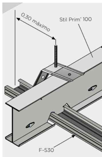
La continuidad de los perfiles Stil Prim® se realiza mediante el empleo de la pieza de empalme Stil Prim® 100, que está formada por dos presillas simétricas que abrazan los dos extremos de los perfiles Stil Prim® a unir.
