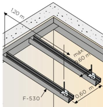
También puede utilizarse el perfil clip: un perfil perimetral de acero galvanizado en forma de U. Una vez el perfil F530 queda alojado en el interior del perfil clip, evita que éste se levante al atornillar las placas de yeso laminado.
