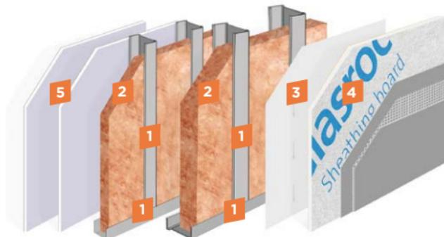
1. Replanteo de las estructuras exterior e interior, marcando sobre suelo y techo. Instalación de las estructuras.
