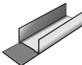
Los raíles se anclarán al soporte (solado o forjado) por medio de tacos de expansión o remaches, distanciados como máximo 600 mm.
