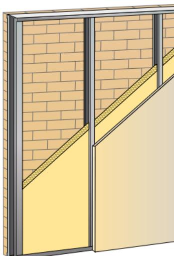
Los railes se fijan a los forjados, colocando una banda estanca, insertándose en ellos los montantes verticales, siendo la modulación entre montantes de 400 ó 600 mm.
