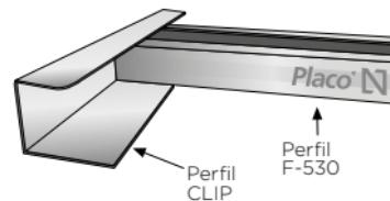
En el caso de que no se instalen perfiles perimetrales, la distancia máxima entre el primer perfil paralelo al elemento divisorio vertical será de 0,10 m, ó de 0,30 m en el caso de que dicho elemento vertical vaya a ser trasdosado.
