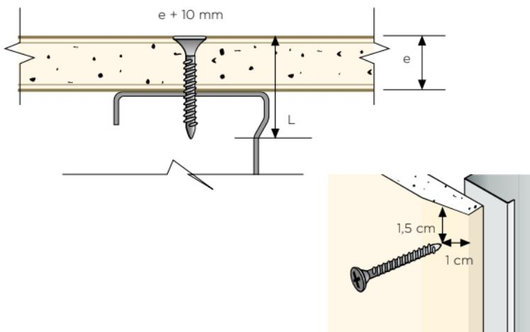
En los paramentos verticales las placas, antes de su atornillado, se apoyarán firmemente a la estructura portante.
