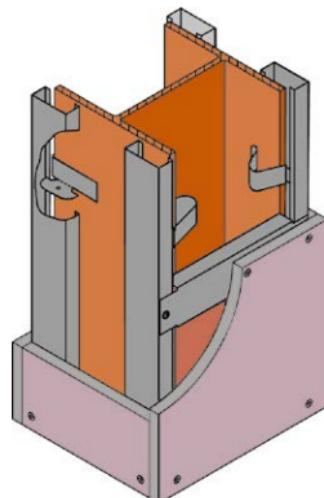
Las placas que forman la primera capa irán fijadas a estos arriostramientos con tornillos TTPC en un mínimo de un punto intermedio si la cara donde se ha instalado es menor a 600 mm, o en intervalos de 300 mm si ésta es superior.
