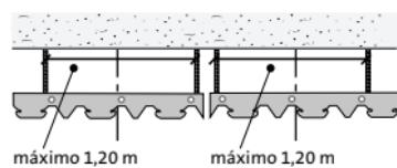
La distancia máxima entre la primera suspensión del **Stil Prim® 50** y el elemento divisorio perpendicular a él, no será mayor de 0,60 m. Se evitará que las uniones entre perfiles primarios contiguos coincidan en la misma línea transversal.
