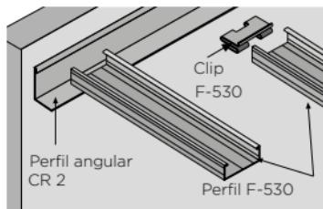
La separación máxima entre el perfil perimetral y la primera suspensión del perfil primario será de 1,20 m y la distancia máxima entre el primer perfil paralelo a la estructura perimetral y éste será de 0,60 m.
