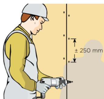
La sujeción de las placas a los montantes se realizará mediante una atornilladora eléctrica con reglaje de profundidad, para que una vez atornillada, la cabeza trompeta de los tornillos no rompa el cartón, quedando perpendicularmente por debajo de la superficie de la placa.
