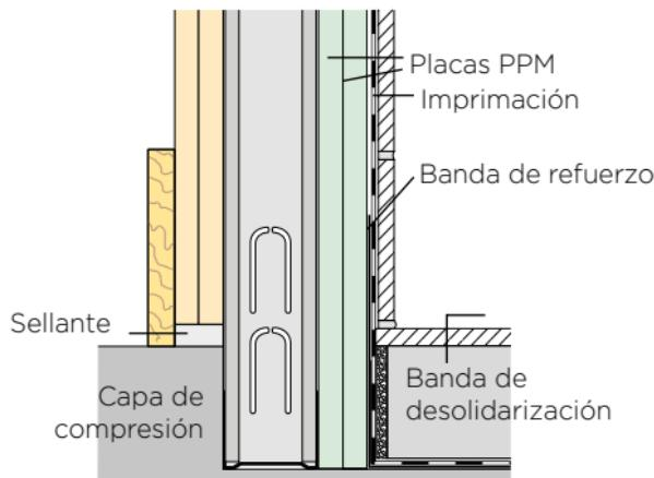
Para asegurar la correcta estanqueidad del tabique, se ha de asegurar un correcto sellado de las juntas entre el revestimiento del tabique, las placas de yeso y cualquier elemento de la instalación eléctrica o de fontanería que traspase el tabique o emerja de él.
