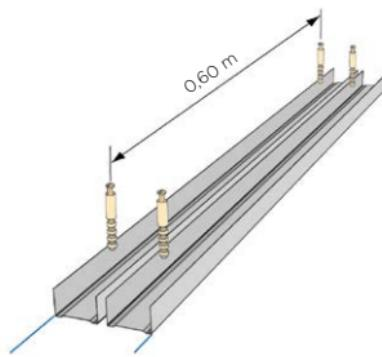
Los montantes de arranque se fijarán en sus encuentros con el resto de elementos verticales de la obra, mediante el empleo de fijaciones mecánicas, siendo la separación máxima entre ellos de 0,6 m.
