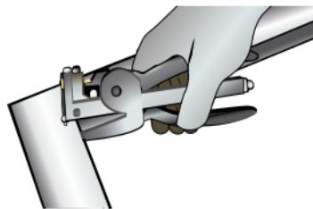
Tal y como se ha indicado, la sujeción de una placa a la estructura metálica se realiza mediante tornillos TTPC.
