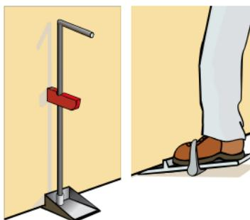
En tabiques sencillos o dobles, las placas se deben colocar en posición longitudinal respecto a los montantes, es decir verticales, de tal manera que sus juntas longitudinales coincidan siempre con un montante.
