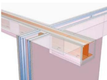
En el caso de protección de pilares, la ejecución de la protección se realizará previamente a la ejecución de los falsos techos.
