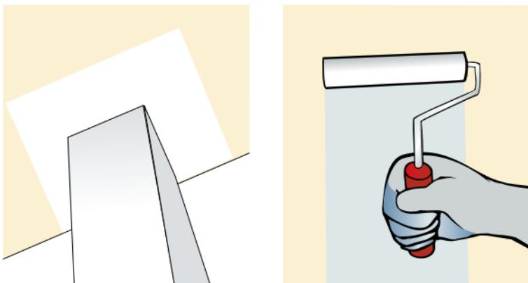
Después de cubrir las cabezas de los tornillos con pasta **Placo® PR Multi**, así como los encuentros y fajeados, esperaremos 24 horas para repasar con lija fina las posibles imperfecciones y **Rigitone®** está listo para ser imprimado y pintado, siempre con rodillo, nunca con spray para no colmatar las perforaciones del velo o tisú.
