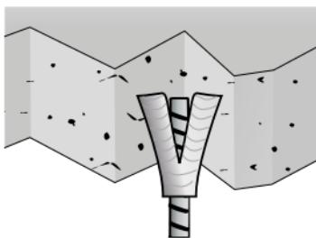
Es de suma importancia escoger el anclaje que ofrezca garantía suficiente para que la unión con el forjado proporcione una carga de trabajo suficiente. En ningún caso inferior a 73 daN y rotura de 220 daN.
