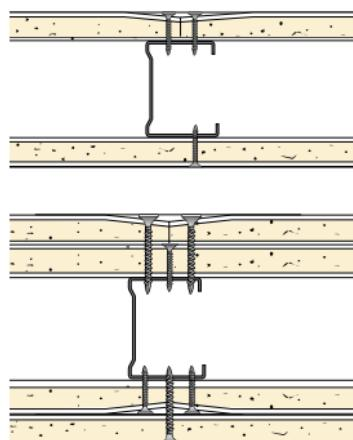
Por ultimo se fijan las placas de la otra cara de la estructura metálica. En el caso de que existan juntas transversales, estas no coincidirán con las de la cara opuesta.
