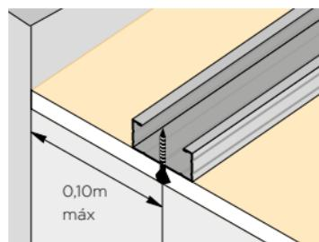
De igual modo, la distancia máxima entre la primera suspensión de los perfiles primarios y el elemento divisorio vertical perpendicular a ellos será de 0,10 m, ó de 0,20 m en el caso de que dicho elemento vertical vaya a ser trasdosado.
