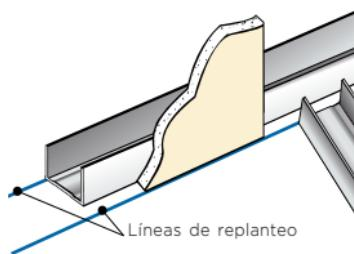
Si es posible, los raíles inferiores se instalarán sobre el solado terminado o sobre su base de asiento. Los raíles superiores "a plomo" de los inferiores.
