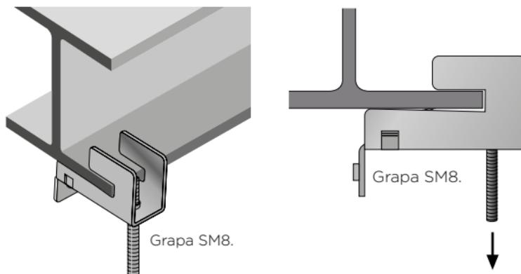
Las grapas SM8 se colocan en las alas de los perfiles metálicos, siempre y cuando el espesor del ala sea igual o inferior a 8 mm.
