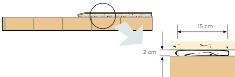
Se cuidará que las placas, una vez instaladas, no se expongan a la humedad excesiva. Al igual que en los tabiques, las placas se instalarán de manera que se levanten del solado acabado unos 10 mm y lleguen al techo quedando pegadas a él. Para ello se utilizarán calzos adecuados. Mediante la regla de "pañear" se llevará la placa al plano replanteado.
