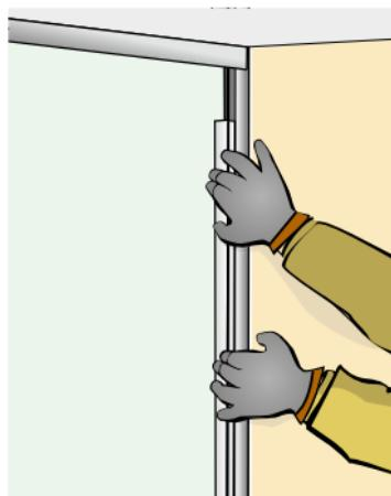
Refuerzo frente al fuego mediante la colocación de lambetas. Para reforzar el aislamiento frente al fuego en la parte superior, insertar una pieza de la placa **Coreboard®** de 19 mm y otra de PPF 15 mm de espesor y 122 mm de ancho entre los montantes en "I".
