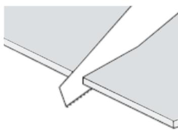
Las placas deben colocarse sobre un soporte plano, una tabla de corte o bien apilarse. Los cortes pueden realizarse fácilmente utilizando sierras circulares de mano, preferiblemente sierras de calar con una aspiración suficiente. La velocidad de corte y la elección de las cuchillas deben definirse a partir del tipo de sierra utilizada.
