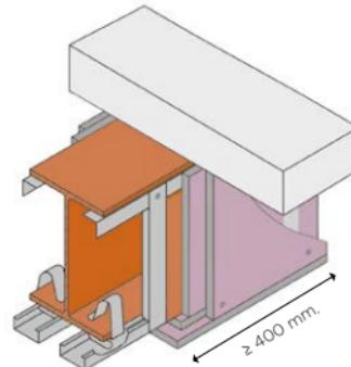
Detrás de las juntas entre placas de esta segunda capa se colocará un recorte de fleje metálico **Megaplac®** que irá fijado con los mismos tornillos TTPC que utilizamos para fijar esta segunda a la primera.
