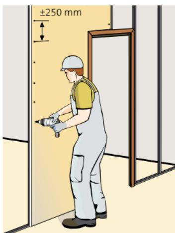
En caso de tabiques de dos o más placas por cada cara, la primera placa se fijará a la estructura mediante tornillos equidistantes como máximo 700 mm.
