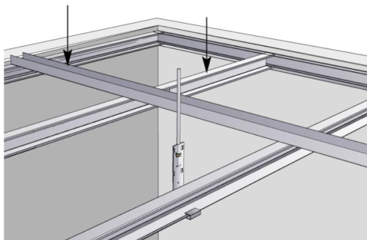
En este sistema siempre se emplean raíles como perfiles perimetrales, siendo los montantes los perfiles a los que se atornillan las placas de yeso laminado, colgándose del soporte mediante varillas M6 y suspensiones MS (montantes simples) ó MD (montantes dobles).
