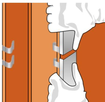
Para la ejecución de la capa interior de protección, se cortan las placas al ancho requerido y se fijan a los F-530 con tornillos TTPC cada 300 mm escalonando las juntas entre caras contiguas.
