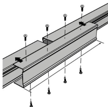
En la instalación de montantes simples con arriostamiento superior, la unión entre los perfiles se realizará mediante tornillos TRPF, uniendo el alma del raíl con el ala superior del montante.
