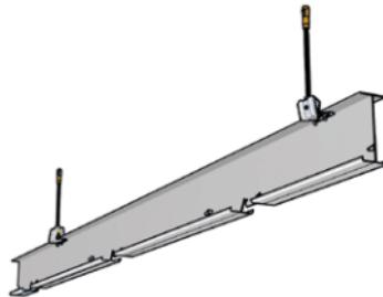
Fijación de la Suspensión **Stil Prim® 100 1/4** de vuelta al alma del perfil mediante 2 tornillos TTPF.
