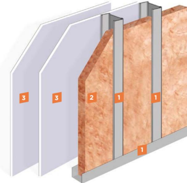
1. Replanteo de la estructura interior, marcando sobre suelo y techo. Instalación de la estructura.
