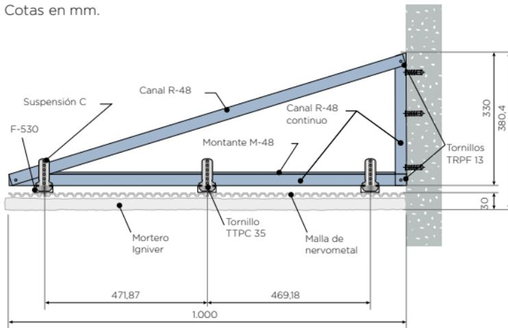
Formada por malla de Nervometal de 0,40mm de espesor, mortero Igniver de 30,5 mm de espesor, fijadas a las escuadras soporte de **Placo®**, confeccionadas con Railes de 48 mm, Montantes de 48 mm y F-530, tornillería.
