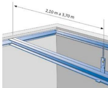
La distancia máxima entre el primer perfil paralelo a la estructura perimetral y ésta será de 0,60 m.
