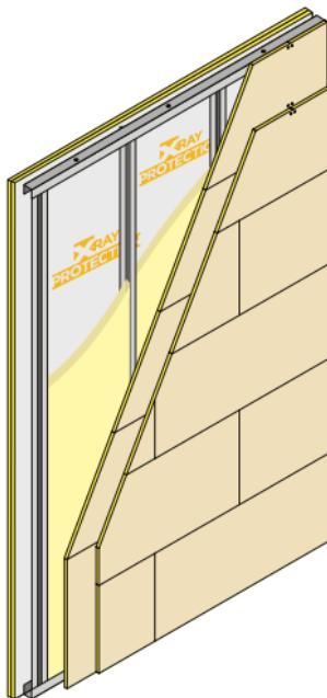
Se fijan horizontalmente a la estructura metálica con montantes modulados como máximo a 600 mm. Las placas de las capas interiores se fijan a la estructura metálica usando tornillos HD únicamente en su perímetro.
