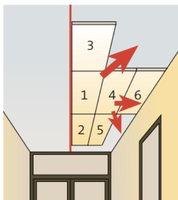
La gama Rigitone® Edge dispone de cuatro bordes biselados para una instalación rápida sin el uso de herramientas de alineación.
