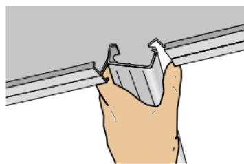
Los extremos de los perfiles Stil Prim® se unen a tope, fijando a continuación la pieza de unión mediante tornillos TRPF.
