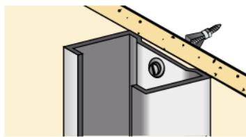
Se podrán emplear tornillos TTPC en los arranques, cruces o esquinas donde existan perfiles en la otra cara de la placa o placas.
