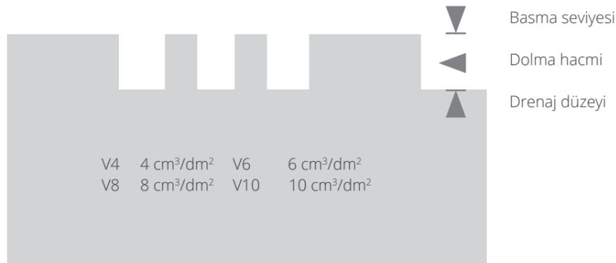
Yer değiştirme alanı (V4-V10) üzerinde yürünen üst dolaşım yüzeyi ile profilli yüzeylerin drenaj düzeyi arasındaki açık alandır.
