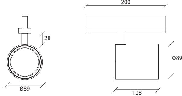
**LED MODULE / MODULE LED**
