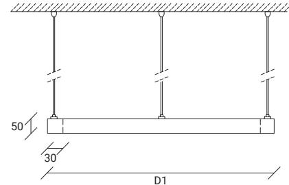
**LED MODULE / MODULE LED**
