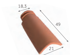
Demi-tuile (utilisation en tuile de couvert pour la finition à l'égout) 2,5 au m 2,5 kg/pièce
