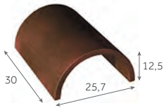
Faîtière bout-à-bout demi-ronde de 30 3,33 au m 4,2 kg/pièce
