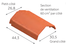
Faîtière à pans de 40 ventilée 2,5 au m 6 kg/pièce
