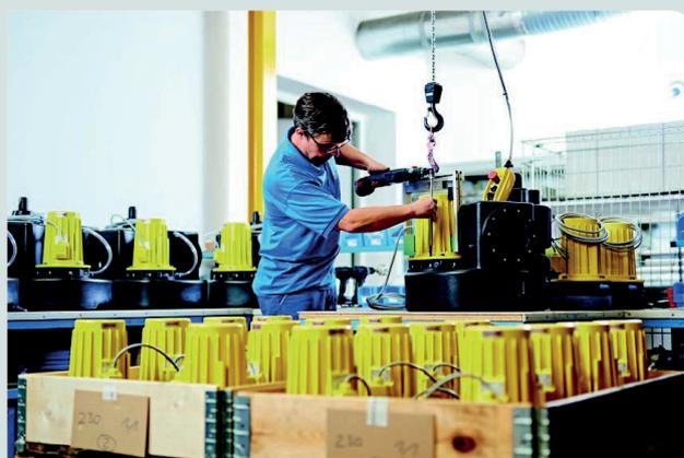
Zehnder Pumpen a été l'une des premières entreprises à produire une station de relevage innovante avec cuve en plastique de haute qualité. La fabrication sur site des cuves nous permet de répondre spécifiquement à chaque demande. Les différents contrôles sont également effectués dans l'usine.
