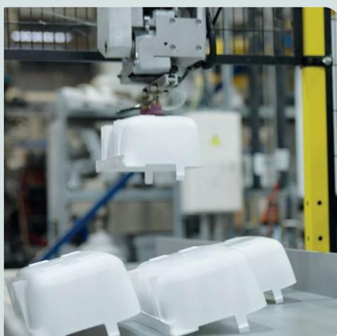
SFA possède 42 machines pour un total de près de 800 moules. La chaîne est totalement automatisée : de l'acheminement des paillettes de plastique depuis les silos aux machines jusqu'à la sortie des produits.
