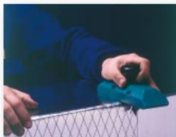
Su exclusivo sistema de doble cuchillas permite un corte limpio con precisión y rapidez. La primera cuchilla, de avance, permite un primer corte del revestimiento exterior del conducto; la segunda, remata cortando el revestimiento interno.
