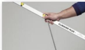
La regla escuadra dispone de un sistema de click de diseño exclusivo que facilita y acelera el cambio de ángulos entre las dos partes, como su apertura y cierre.
