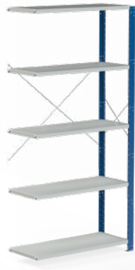
MIX påbyggnadssektion, 5 hyllplan, öppen gavel Höjd: 1740 eller 2100 mm. Bredd: 605, 805, 1005 eller 1305 mm. Djup: 300*, 400, 500 eller 600 mm. Maxbelastning 150 kg per hyllplan.
