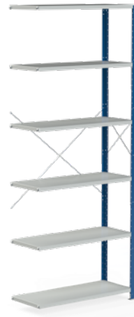
MIX påbyggnadssektion, 6 hyllplan, öppen gavel Höjd: 2500 eller 3000 mm. Bredd: 605, 805, 1005 eller 1305 mm. Djup: 400, 500 eller 600 mm. Maxbelastning 150 kg per hyllplan.
