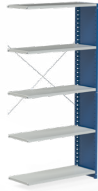
MIX påbyggnadssektion, 5 hyllplan, täckt gavel Höjd: 1740 eller 2100 mm. Bredd: 605, 805, 1005 eller 1305 mm. Djup: 400, 500 eller 600 mm. Maxbelastning 150 kg per hyllplan.
