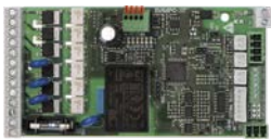
ORU10/ORBU10 OPower Netzkarte für asynchronen/Brushless Motor, für BMS
