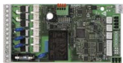
ORT10/ORBT10 OPower Netzkarte für asynchron/Brushless Motor, für BMS
