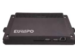
ORS940 - Round Net Supervisore per sistemi medio/ grandi (fino a 250 unità)
