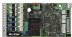
ORU10/ORBU10 Carte OPower asynchrones/sans balais pour BMS
