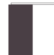
Porta ad un anta scorrevole esterno muro con manlovana ma senza telaio One leaf sliding outside the wall
