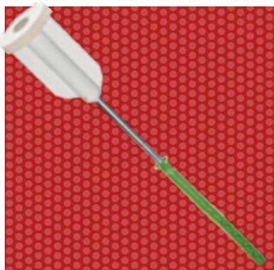
Elemento di fissaggio costituito da una boccola di montaggio in materiale plastico con guarnizione di tenuta in EPDM ed un tassello per facciata ( $\varnothing$  8 mm). BIO SUPPORT MEDIUM viene utilizzato per il montaggio di carichi non pianificati da leggeri a medi (fino a 15 kg) su sistemi ETICS in EPS, lana minerale.
