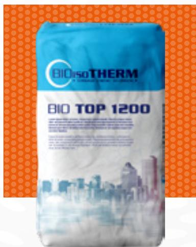
Rasante e collante minerale di colore bianco certificato UNI EN 998-1 per pannelli isolanti in polistirene espanso ed intonaci base calce e calce cemento. Adatto all'utilizzo per strati di rasatura di 5 mm di spessore. Granulometria max inerte 1,2 mm.
