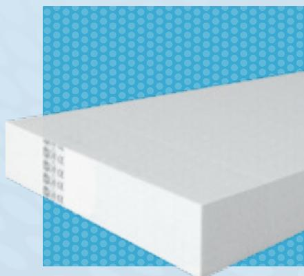
Pannelli in polistirene espanso sinterizzato di colore bianco, conformi ai Criteri Ambientali Minimi, adatti all'utilizzo su pareti esterne degli edifici per la realizzazione di sistemi di isolamento a cappotto. Certificati secondo la Norma Armonizzata UNI EN 13163, marcatura CE ed autoestinguenti (RF in Euroclasse E).
