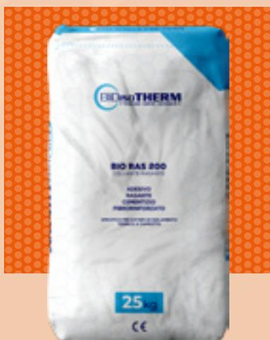
Rasante e collante minerale di colore grigio certificato UNI EN 998-1 per pannelli isolanti in polistirene espanso ed intonaci base calce e calce cemento. Adatto all'utilizzo per strati di rasatura di 5 mm di spessore. Granulometria max inerte 0,8 mm.
