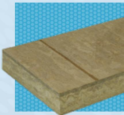
Pannello rigido in lana di roccia non rivestito a doppia densità, per isolamento termico ed acustico. Il pannello viene sottoposto ad un trattamento specifico nel processo produttivo che lo rende idoneo alle severe condizioni di utilizzo tipiche dell'isolamento dall'esterno. Prodotto specificamente concepito per sistemi termoisolanti a capotto.
