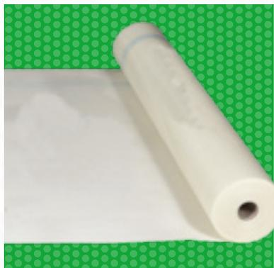
Rete in fibra di vetro indemagliabile e resistente agli alcali, impiegata nei sistemi d'isolamento a cappotto come armatura dello strato di rasatura del pannello isolante. La rete è conforme alla linea guida ETAG 004 per ETICS, ed è dotata di marchio CE e di Qualità.
