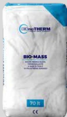
Malta premiscelata termoisolante a base di perle in polistirene espanso, additivi naturali e leganti idraulici, per la realizzazione di sottofondi alleggeriti ed isolanti. Una scelta accurata e selettiva delle materie prime producono con la sola aggiunta di acqua, una malta premiscelata termoisolante, eccezionalmente plastica, facilmente lavorabile ed un'ottima stabilità dimensionale.
