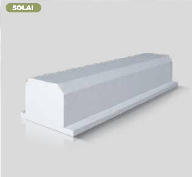
Elemento sagomato termoisolante in polistirene espanso sinterizzato a celle chiuse. Idoneo alla realizzazione di solai alleggeriti ed isolati termicamente. La presenza delle alette sotto-travetto, garantisce un isolamento continuo all'intradosso del solaio.
