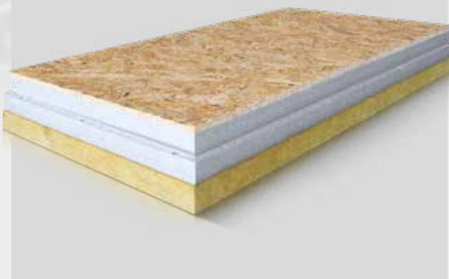
Pannello sandwich termoisolante battentato sui 4 lati, per la coibentazione di coperture, composto da una lastra in polistirene espanso sinterizzato prodotta con materia prima Neopor® accoppiata all'estradosso con un foglio di OSB/3 ed all'intradosso con un pannello in lana di roccia per migliorare lo sfasamento termico.
