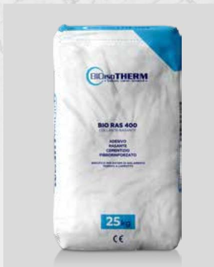
Rasante e collante minerale di colore grigio certificato UNI EN 998-1 per pannelli isolanti in polistirene espanso ed intonaci base calce e calce cemento. Adatto all'utilizzo per strati di rasatura di 5 mm di spessore. Granulometria max inerte 0,8 mm.
