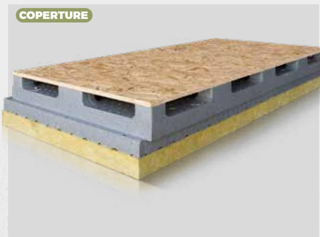
Sistema per la coibentazione e la ventilazione bidirezionale di coperture con tetti a falde, ottenuto con un pannello in polistirene espanso sinterizzato prodotto con materia prima Neopor® accoppiato all'estradosso con un foglio di OSB/3 ed all'intradosso con un pannello in lana di roccia per migliorare lo sfasamento termico, battentato sui 4 lati.
