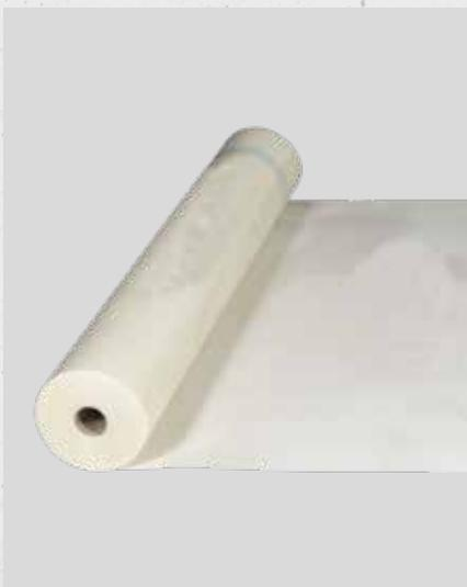
Rete in fibra di vetro indemagliabile e resistente agli alcali, impiegata nei sistemi d'isolamento a cappotto come armatura dello strato di rasatura del pannello isolante. La rete è conforme alla linea guida ETAG 004 per ETICS, ed è dotata di marchio CE e di Qualità.
