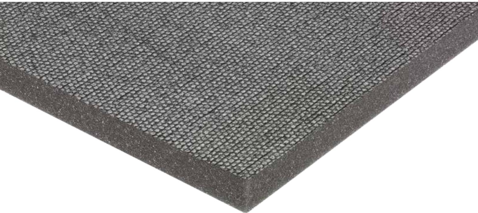
**MAPPYPELL PLATE GOFFRATO ALVEOLARE AU** è un prodotto fonoassorbente composto da una schiuma poliuretanica espansa di tipo autoestinguente non gocciolante flessibile a cellule aperte accoppiata ad un film autoestinguente con superficie goffrata alveolare impermeabile all'acqua, oli e polvere.
