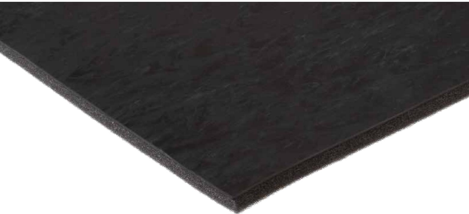
**DUMP CR 101** è un prodotto fonoisolante composto da una schiuma poliuretanica espansa di tipo autoestinguente non gocciolante flessibile a celle aperte accoppiata ad una barriera elastomerica flessibile ad alta densità per aumentare la massa e migliorare l'isolamento acustico.
