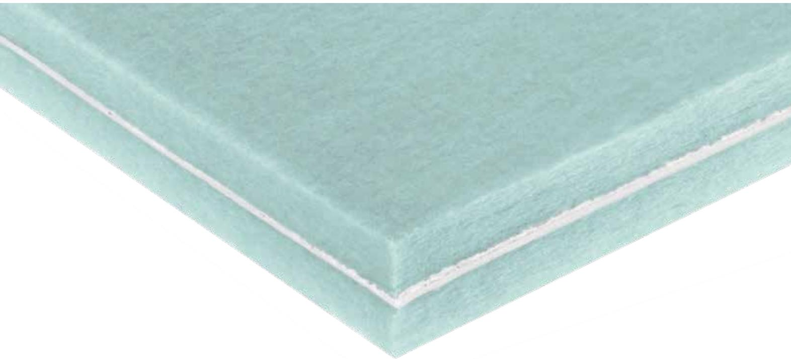
**ISOL SILSONIC BRT 400** è un prodotto fonoisolante composto da due strati di fibre di poliestere 100 % termolegata e rigenerate con interposta una barriera elastomerica in classe B s1 d0 e flessibile ad alta densità per aumentare la massa e migliorare l'isolamento acustico. I materassini in fibra di poliestere hanno lo scopo di disaccoppiare la barriera pesante dalla fonte di rumore.
