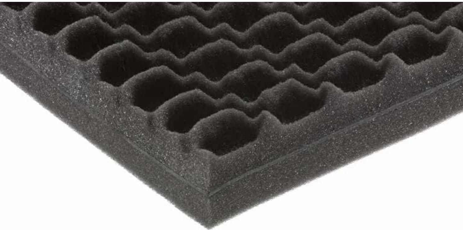
**MAPPYSIL CR BUGNATO DISEGNO 3** è un prodotto fonoisolante composto da due strati di schiuma poliuretanica espansa di tipo autoestinguente non gocciolante, di cui uno bugnato, con interposta una barriera elastomerica flessibile ad alta densità per aumentare la massa e migliorare l'isolamento acustico. La schiuma di poliuretano ha lo scopo di disaccoppiare la barriera pesante dalla fonte di rumore.
