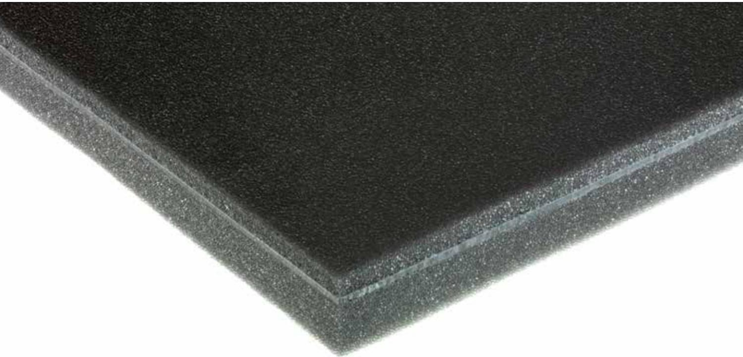
**MAPPYSIL CR RE** è un prodotto fonoisolante composto da due strati di schiuma poliuretanica espansa di tipo autoestinguente non gocciolante, con interposta una barriera elastomerica flessibile ad alta densità per aumentare la massa e migliorare l'isolamento acustico. La schiuma di poliuretano ha lo scopo di discoppiare la barriera pesante dalla fonte di rumore. Questo prodotto è disponibile anche in versione adesiva con collante acrilico a base d'acqua.
