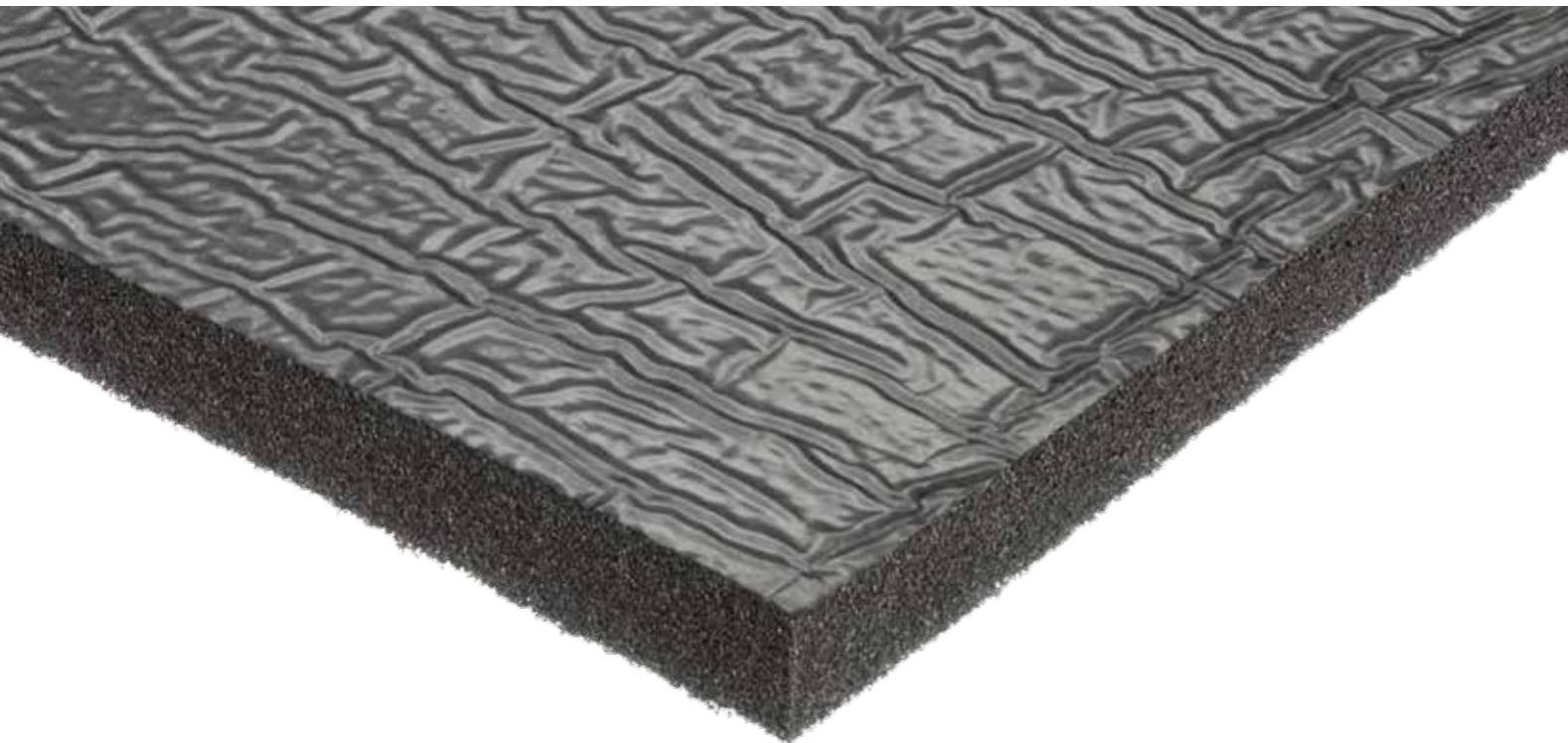
**STOPFIRE PLATE LISCIO** è un prodotto fonoassorbente in poliuretano espanso impregnato con additivi FR che lo rendono un materiale in classe di reazione al fuoco C s2 d0. La struttura a cellule aperte gli conferisce leggerezza, flessibilità e facilità di compressione. La superficie è rivestita da un film autoestinguente impermeabile all'acqua, oli e polvere. Questo prodotto è disponibile anche in versione adesiva con collante acrilico a base d'acqua.
