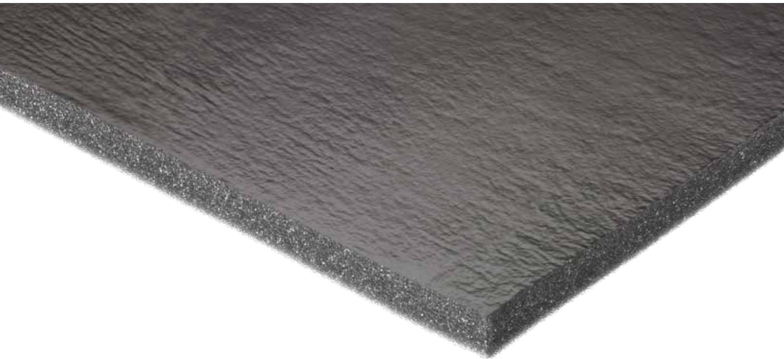
**MAPPYPELL PLATE LISCIO AU** è un prodotto fonoassorbente composto da una schiuma poliuretanica espansa di tipo autoestinguente non gocciolante flessibile a cellule aperte. La superficie è coperta da un film autoestinguente impermeabile all'acqua, oli e polvere. Questo prodotto è disponibile anche in versione adesiva con collante acrilico a base d'acqua.
