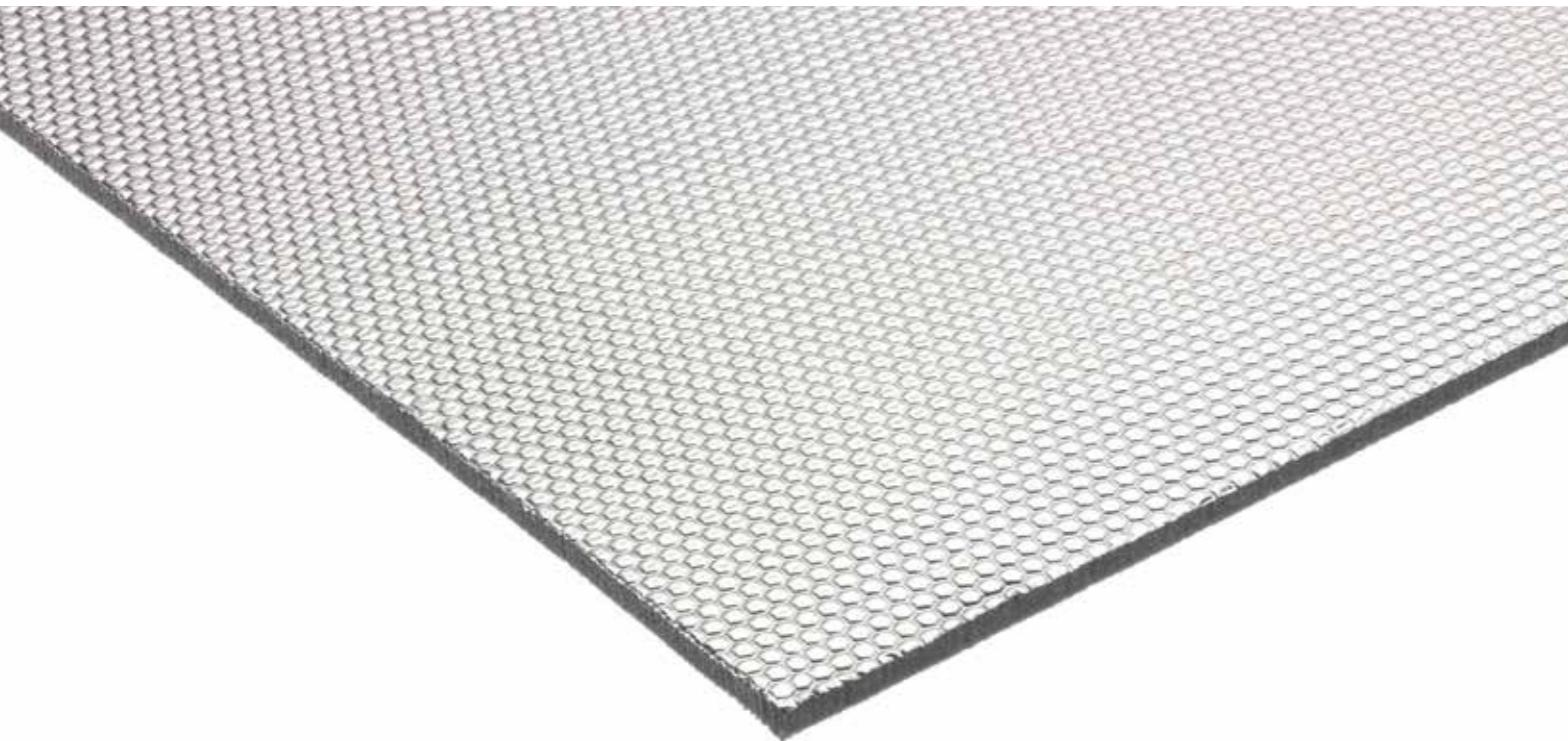
**TERMOFLEX PLT GOFFRATO** è un prodotto termoisolante e anticondensa in polietilene espanso reticolato rivestito da uno strato di alluminio termoriflettente. La struttura a cellule chiuse lo rende leggero ed elastico. Ha un'ottima resistenza alle sollecitazioni meccaniche e agli agenti atmosferici.
