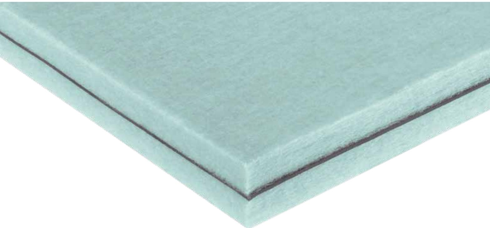
**MAPPYSIL CR 400** è un prodotto fonoisolante composto da due strati di fibre di poliestere 100 % termolegati e rigenerate con interposta una barriera elastomerica flessibile ad alta densità per aumentare la massa e migliorare l'isolamento acustico. I materassini in fibra di poliestere hanno lo scopo di disaccoppiare la barriera pesante dalla fonte di rumore. Questo prodotto è disponibile anche in versione adesiva con collante acrilico a base d'acqua. Resistente all'umidità.
