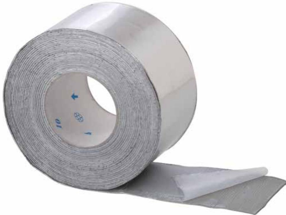
**BUTYFLEX T250 AL** è una guaina adesiva antirombo in gomma butilica elastica e sigillante con un lato rivestito di alluminio resistente agli strappi. È di facile applicazione e garantisce un'impermeabilizzazione perfetta e di lunga durata. Non sborda, è privo di solventi ed è facilmente removibile. È resistente ai raggi UV, e all'acqua. Può essere applicato su lamiere, laminati plastici, vetro, legno e PVC.
