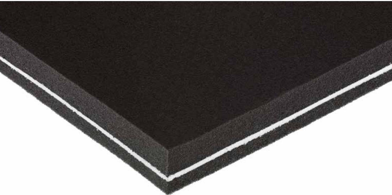
**STOPFIRE BRT LISCO** è un prodotto fonoisolante composto da due strati di schiuma poliuretanica espansa impregnata con additivi FR, con interposta una barriera elastomerica B s1 d0 flessibile ad alta densità per aumentare la massa e migliorare l'isolamento acustico. La schiuma di poliuretano ha lo scopo di disaccoppiare la barriera pesante dalla fonte di rumore. Questo prodotto è disponibile anche in versione adesiva con collante acrilico a base d'acqua.
