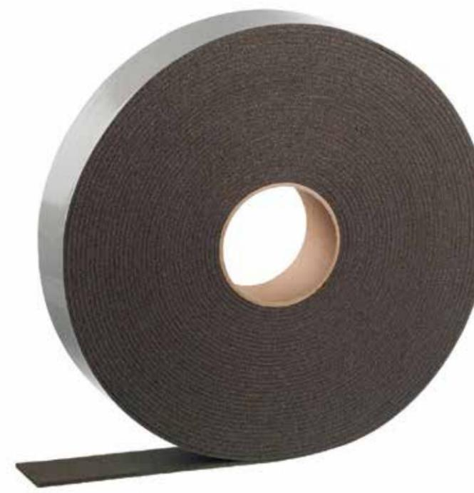
**POLISTIK CH** è un nastro sigillante autoadesivo in polietilene espanso reticolato a cellule chiuse. Ha eccellenti proprietà meccaniche e resistenza agli agenti atmosferici. **POLISTIK CH** è il prodotto ideale per proteggere dalle dispersioni di calore e dalla condensa qualsiasi condotta HVAC e impianto di refrigerazione.
