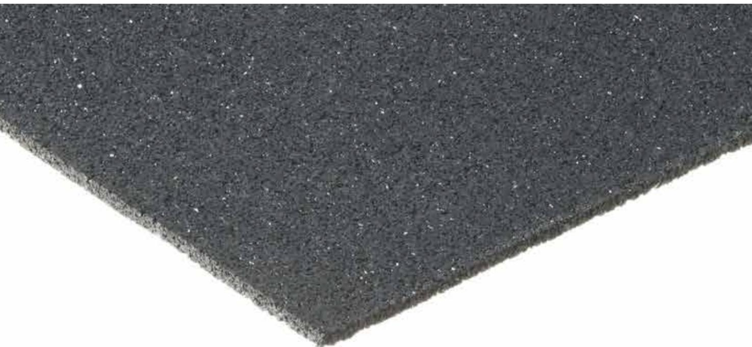
**PAVISOL** è un materassino anticalpestio composto da granuli di gomma riciclata. È il prodotto ideale per l'isolamento acustico di pareti divisorie orizzontali perché compatibile con tutti i tipi di massetto. Può essere utilizzato sia sotto pavimenti galleggianti che sopra lastre prefabbricate in calcestruzzo.
