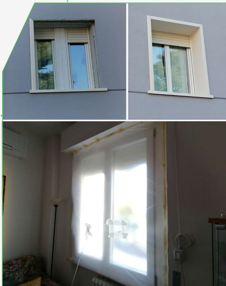
Immagine delle prove in opera per la verifica delle infiltrazioni di aria.
