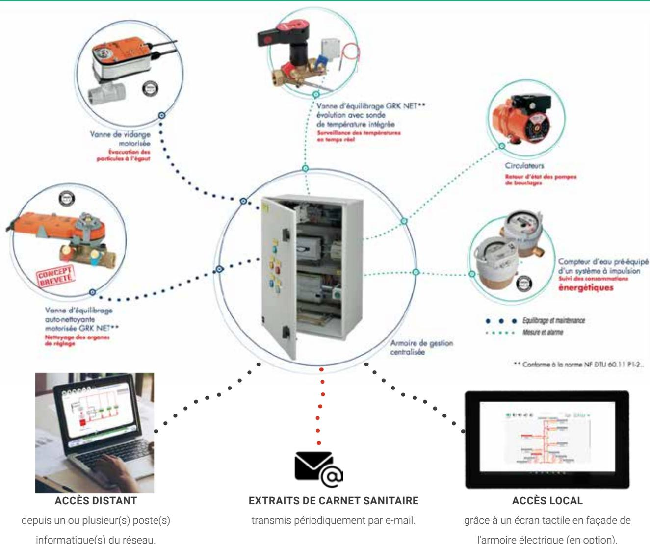
Solutions d'équilibrage et de surveillance des réseaux sanitaires bouclés
