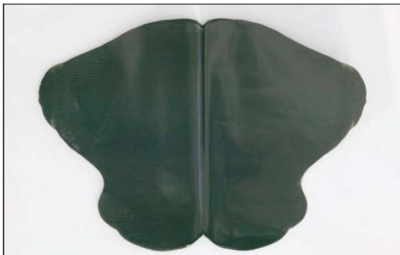
Abb. 13: Positives Testergebnis = ideale Mischung (Schmetterlingstest)
