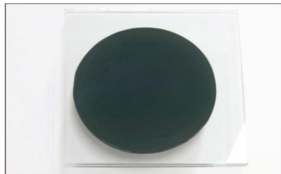
Abb. 11: Positives Testergebnis = ideale Mischung (Marmortest)
