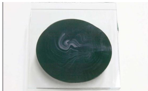
Abb. 12: Negatives Testergebnis = unzureichende Mischung
