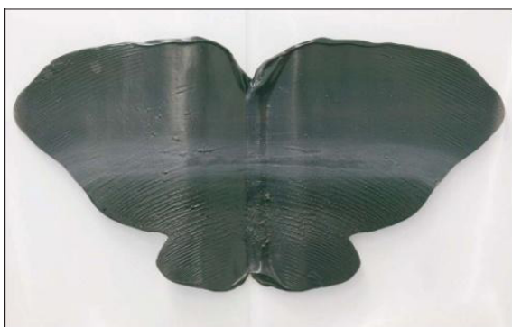
Abb. 14: Negatives Testergebnis = unzureichende Mischung (Schmetterlingstest)
