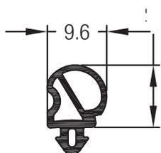
Anschlagdichtung Top Swing EPDM
