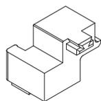
Dichtkissen Mittelschluss oben außen
