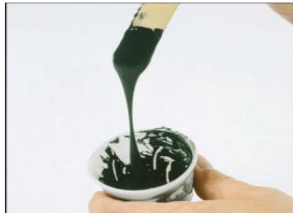
Abb. 15: Das Material zeigt ein pastöses Verhalten: Topfzeit noch nicht erreicht.
