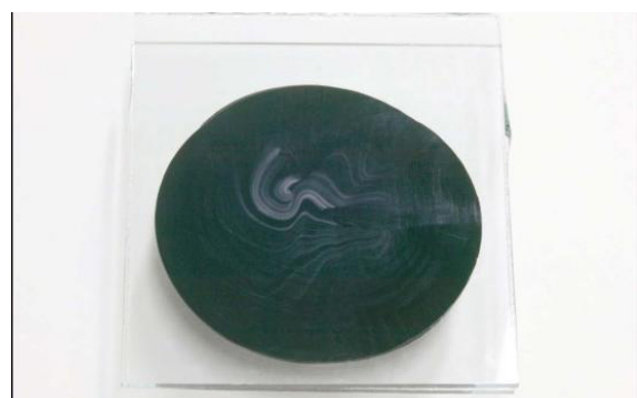
Abb. 12: Negatives Testergebnis = unzureichende Mischung
