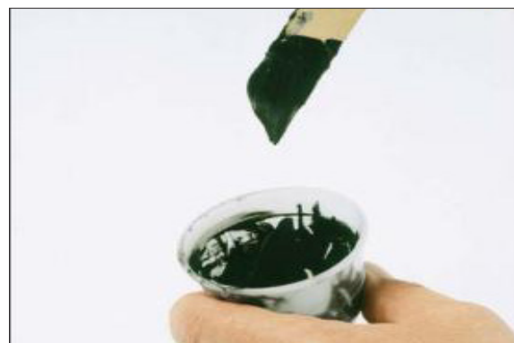
Abb. 16: Das Material zeigt ein gummiartiges Verhalten:
