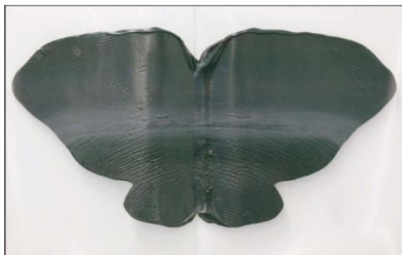
Abb. 14: Negatives Testergebnis = unzureichende Mischung (Schmetterlingstest)
