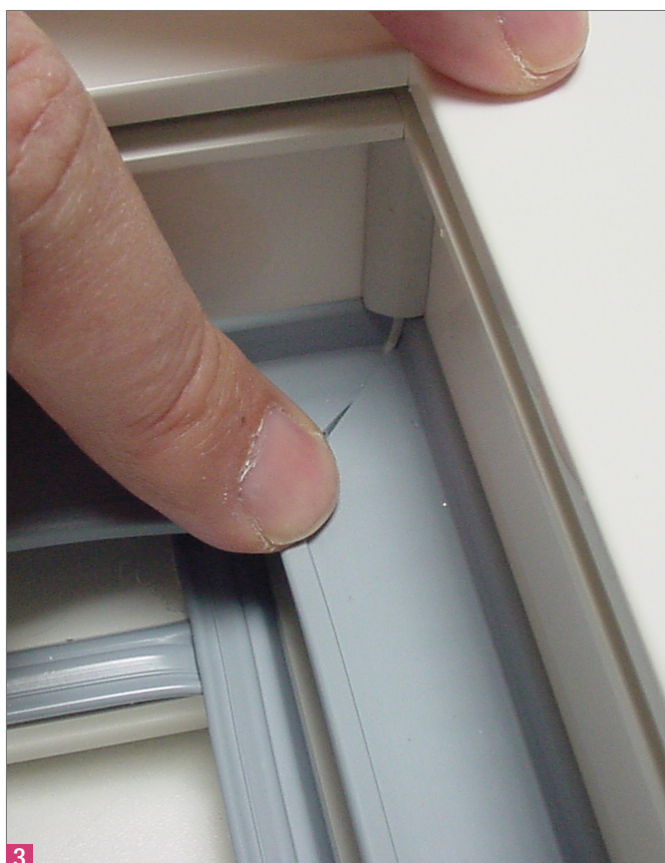
3 Mitteldichtung fügen. Dabei Dichtfläche bündig ausrichten.
