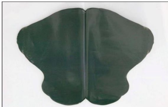
Abb. 13: Positives Testergebnis = ideale Mischung (Schmetterlingstest)
