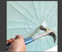
DOPPIO VETRO STRATIFICATO DI SICUREZZA DOUBLE LAMINATED SECURITY GLASS
