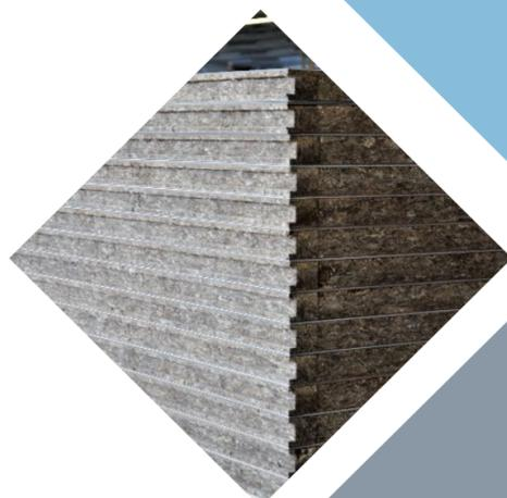
Distintos fresados para diferentes tubos de unión entre paneles.
