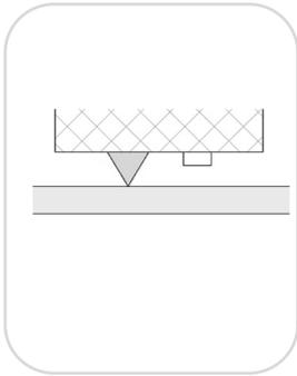
Les panneaux de façade sont fixés à la structure de support en bois ou en métal à l'aide d'un système adhésif élastique.
