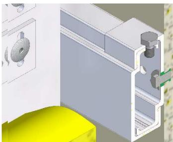
En raison de la nature de la fixation mécanique invisible, il est recommandé de poser les panneaux de bas vers le haut. En fait, il est difficile pour l'installateur de régler ou de fixer les panneaux, ceci en raison du manque d'espace libre suffisant au-dessus du panneau de façade. Les panneaux de façade sont supportés individuellement et n'appuient pas les uns sur les autres (joint de 8 mm autour du panneau), de sorte que les bords ne sont pas endommagés.
