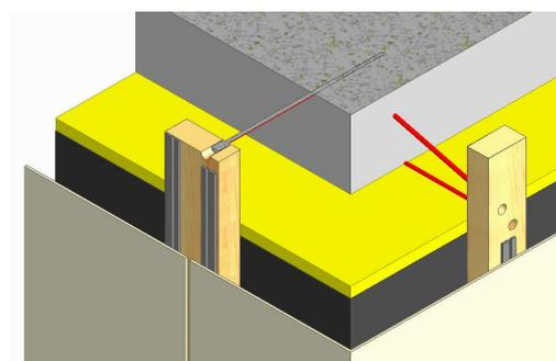
Les vis de réglage sont fabriquées en acier galvanisé. Elles sont fixées dans le gros œuvre avec une cheville qui est spécifiquement appropriée pour le matériau dont le sous-sol est composé.
