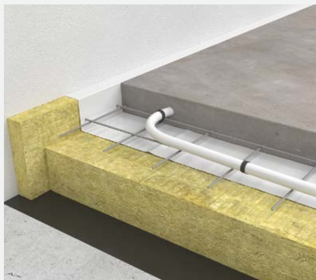
Ułożenie podkładu cementowego.
